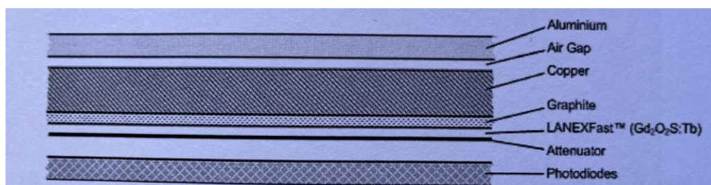
Figura 2.5: strati di componenti che formano il detettore.
