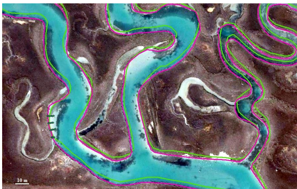
Figura 6.9. Diminuzione della sinuosità ed aumento della larghezza del canale oggetto di studio dal 2007 (verde) al 2014 (rosa).
