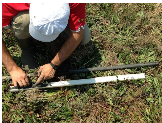
Figura 4.3. Fase di trasferimento di una carota all'interno del portacampione in PVC.
