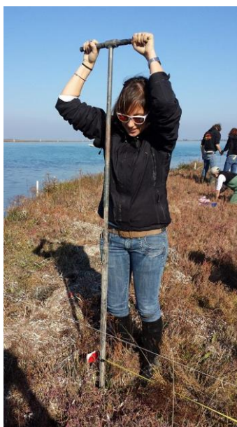
Figura 4.2. Carotatore manuale in fase d'infissione.
