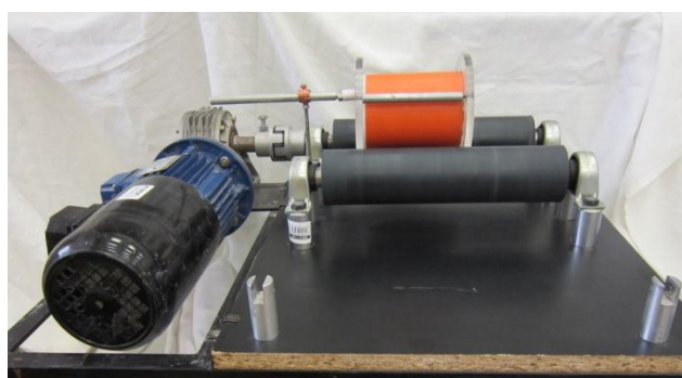
Figure 2.1 e 2.2: Foto scattate prima e durante l'esecuzione del ball milling. A sinistra (figura 2.1) sono riportati il recipiente in plastica contenente la sospensione di fase attiva e le sferette in ceramica per la macinazione. A destra (figura 2.2) è riportata l'intera apparecchiatura utilizzata nello svolgimento della macinazione.
