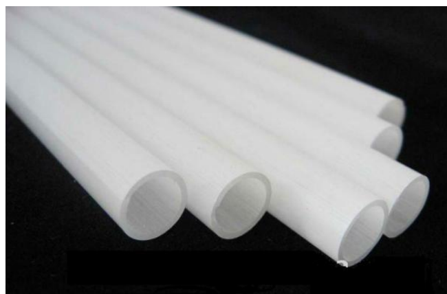
Figura 3.3: Tubi in quarzo come quelli utilizzati nel reattore.
