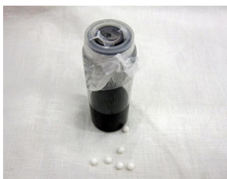
Figure 2.1 e 2.2: Foto scattate prima e durante l'esecuzione del ball milling. A sinistra (figura 2.1) sono riportati il recipiente in plastica contenente la sospensione di fase attiva e le sferette in ceramica per la macinazione. A destra (figura 2.2) è riportata l'intera apparecchiatura utilizzata nello svolgimento della macinazione.
