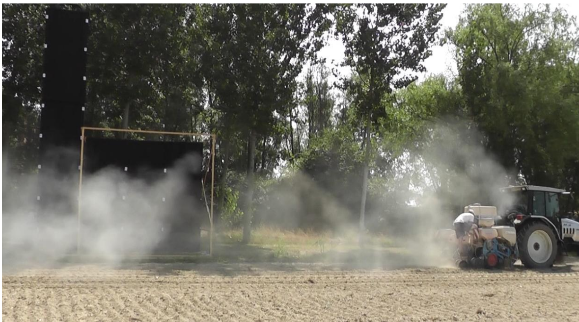
Immagine 19: seminatrice pneumatica durante le prove con in evidenza la nuvola di polvere emessa e che permane in sospensione.
