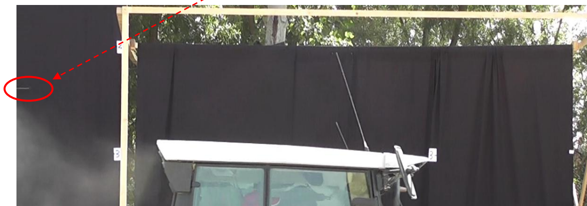
Immagine 20: serie di immagini che ritraggono il passaggio della seminatrice durante le prove con la simulazione della polvere con il talco, si possono notare con i cerchietti rossi le api. Con la freccia tratteggiata si nota la stessa ape come si è spostata durante la sequenza delle immagini estratte da uno dei filmati svolti, l'ape supera il trattore di pochi centimetri e non accenna di schivare la nube.
