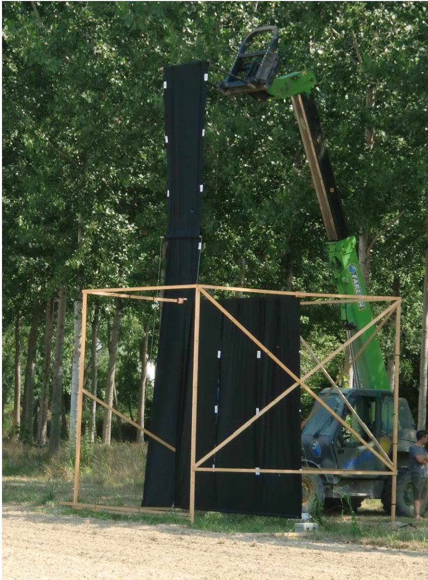
Immagine 14: struttura mobile per il sostegno del telo che funge da sfondo uniforme per le riprese delle prove
