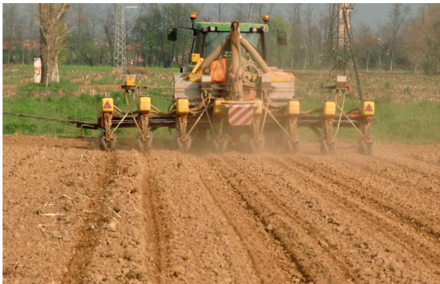
Immagine 8: seminatrice pneumatica di precisione da mais.
