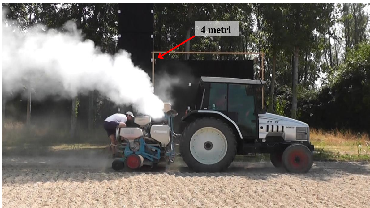
Immagine 18: immagini scattate in sequenza durante il transito della seminatrice durante le prove, si può notare l'ampiezza della nube sviluppatasi con l'introduzione di talco per simulare la nube di particolato
