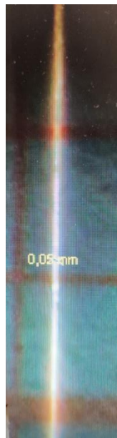
Fig. 11 dimensione della fessura misurata con tools elettronico del software della LAF.
