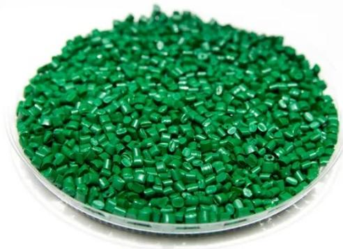
*Fig. 1.3: fotografia di pellets prima del processo di stampaggio ad iniezione.*
