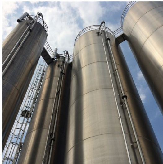
Figura 3.9: silos, tipico ambiente in cui è presente il rischio di spazi confinati (wikipedia)
