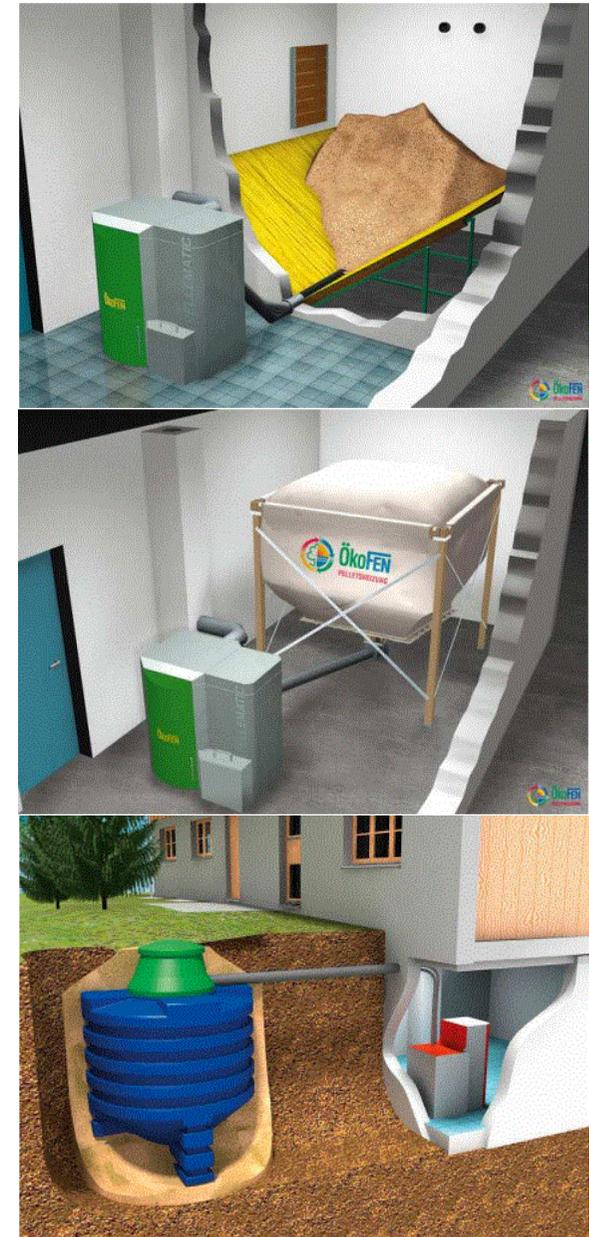
Figura 1.32. Sistemi di stoccaggio del pellet, dall'alto: vano pellet, serbatoio in tessuto, silo sotterraneo
