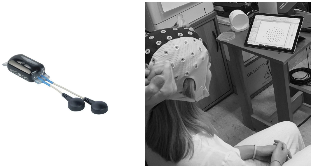
figura 8: a sinistra, il sensore MiniWave EMG 21 , a destra, applicazione della cuffia durante lo studio in laboratorio.
