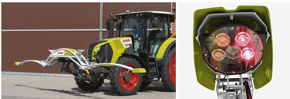
Figura 2.1: Sensori a infrarossi Claas montati su mezzo (sinistra) e dettaglio del sensore (destra)
