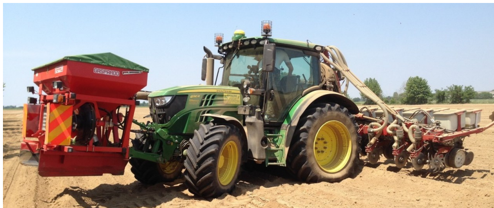
Figura 2.2: Seminatrice di precisione KWS accoppiata a sistema di guida satellitare John Deere (montata su tettuccio)
