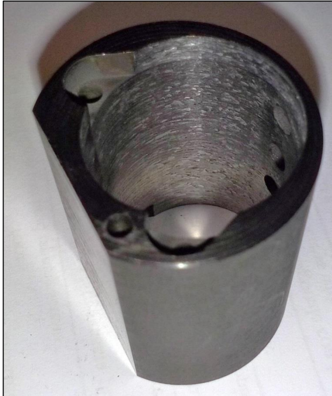
Figura 6-27: statore dopo i test con le palette in alluminio
