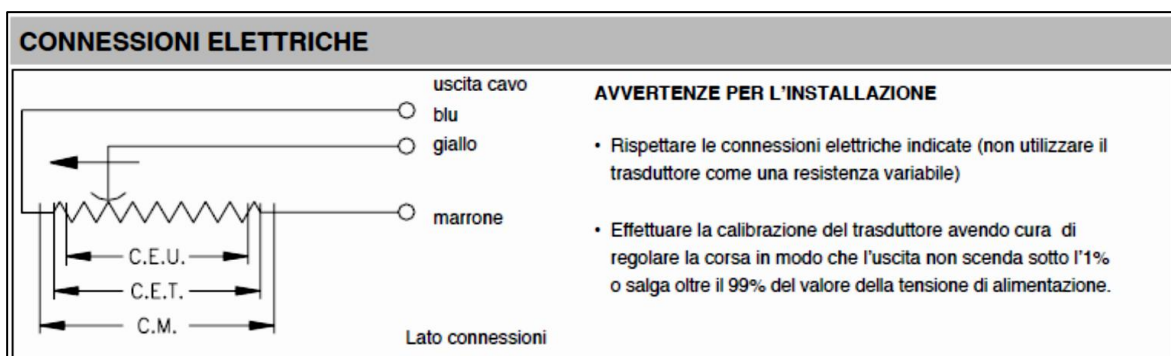
Figura B-3 : schema connessioni potenziometro.
