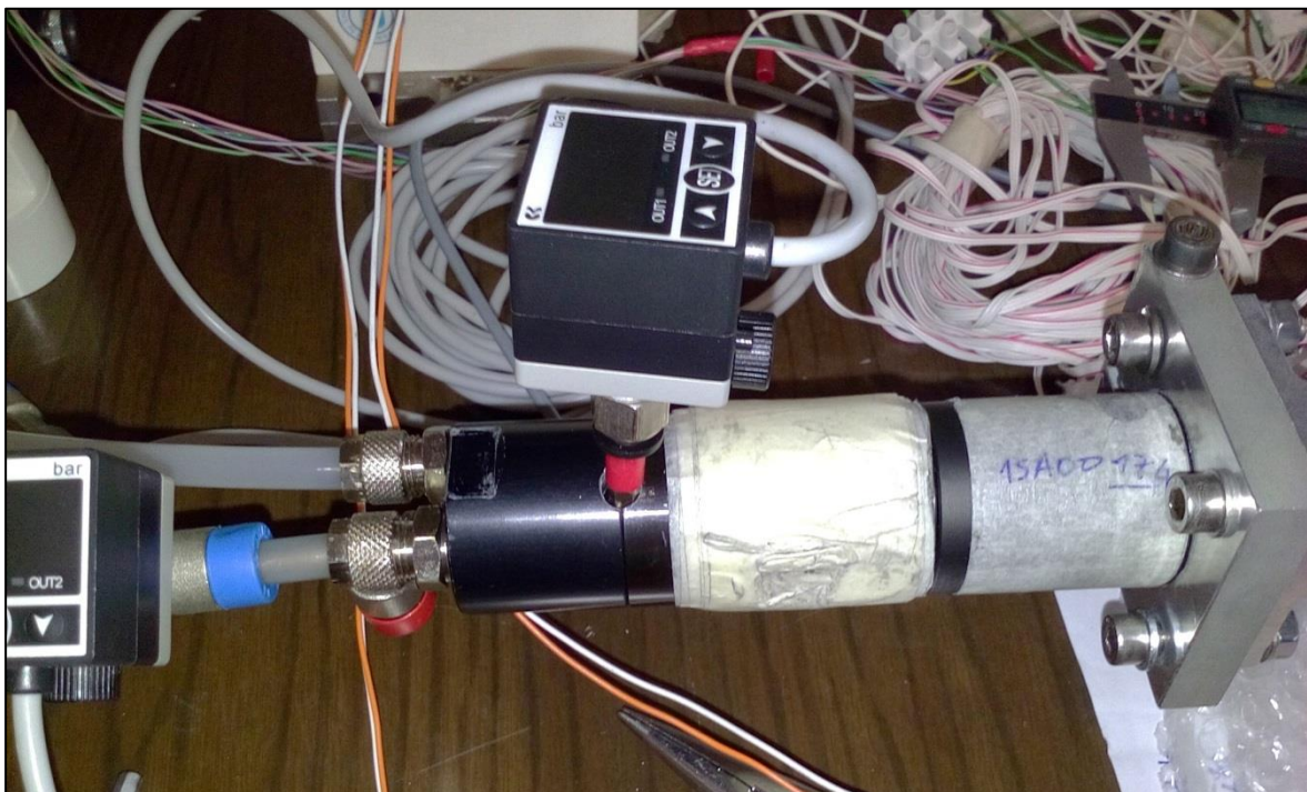
Figura 5-4: pressostato montato grazie alla modifica effettuata.
