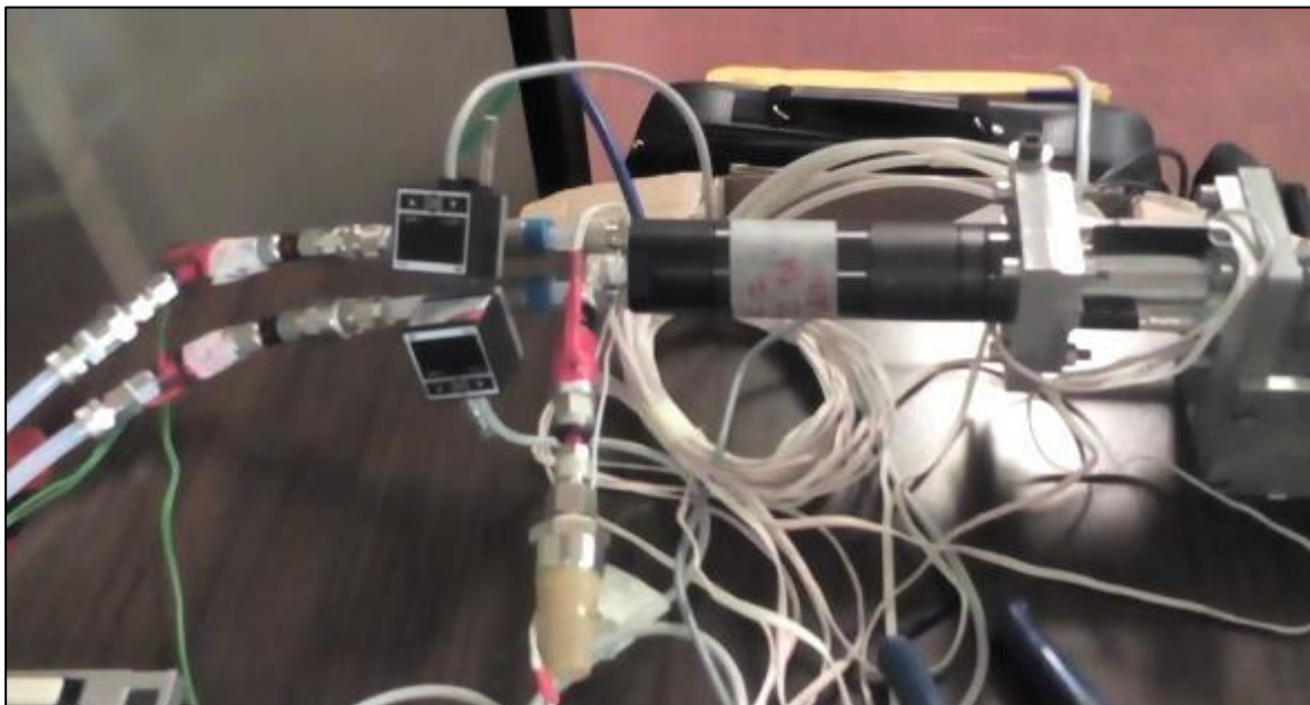
Figura 4-19 : pressostati installati sul test bench.
