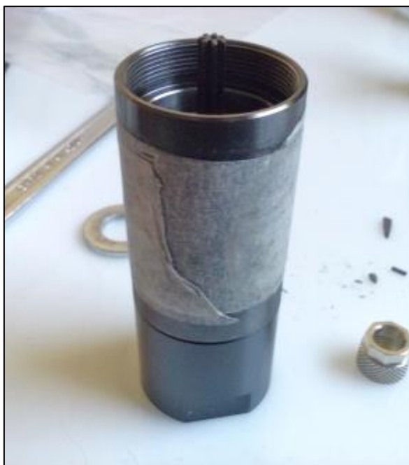
Figura C-6: corpo cilindrico avvitato sul fondello
