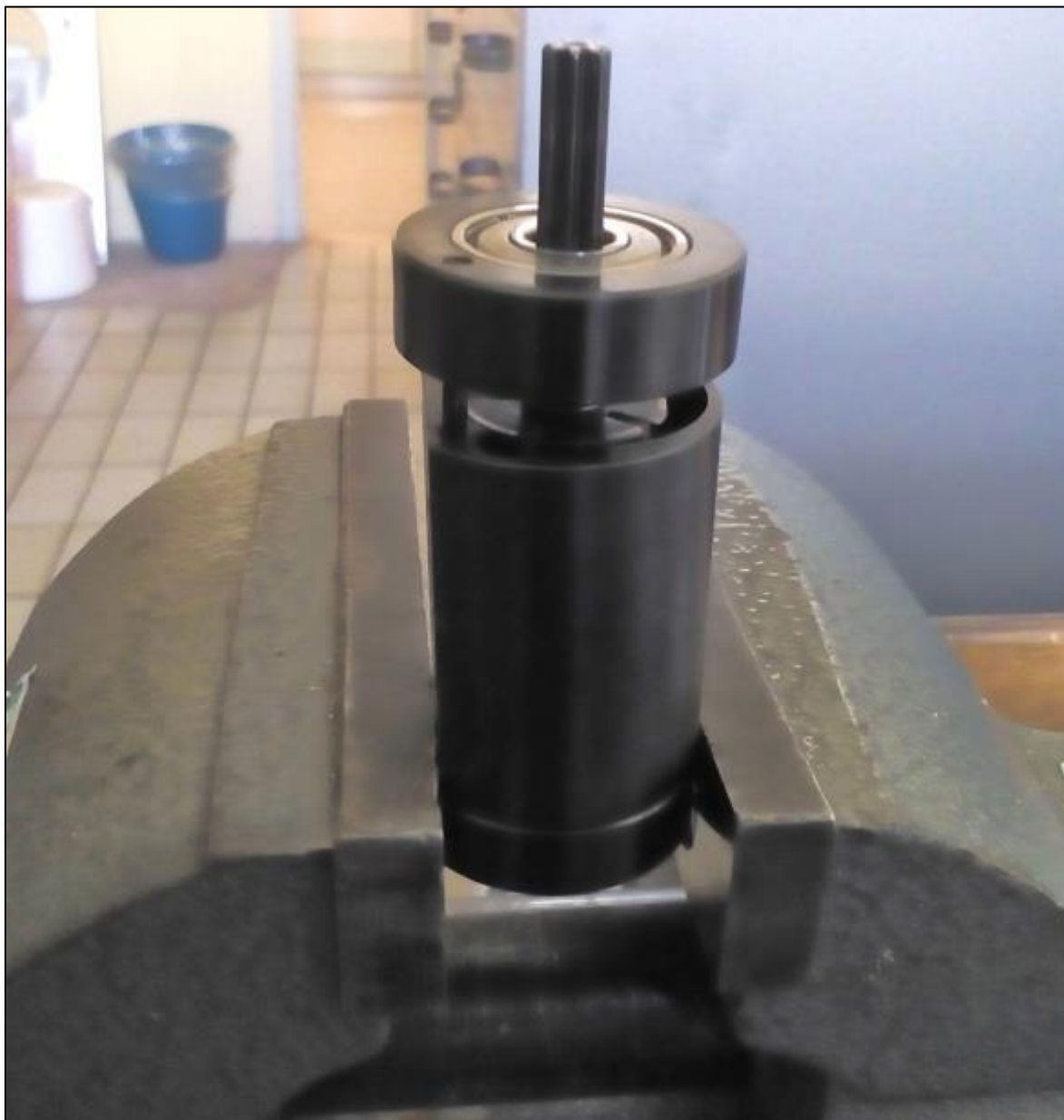
Figura C-3 : inserimento del coperchio di chiusura.
