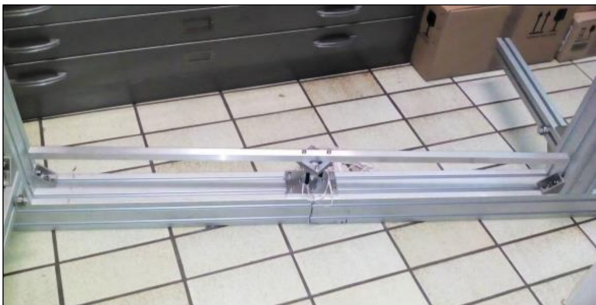
Figura 4-14 . dispositivo per la tarature della catena di misura.
