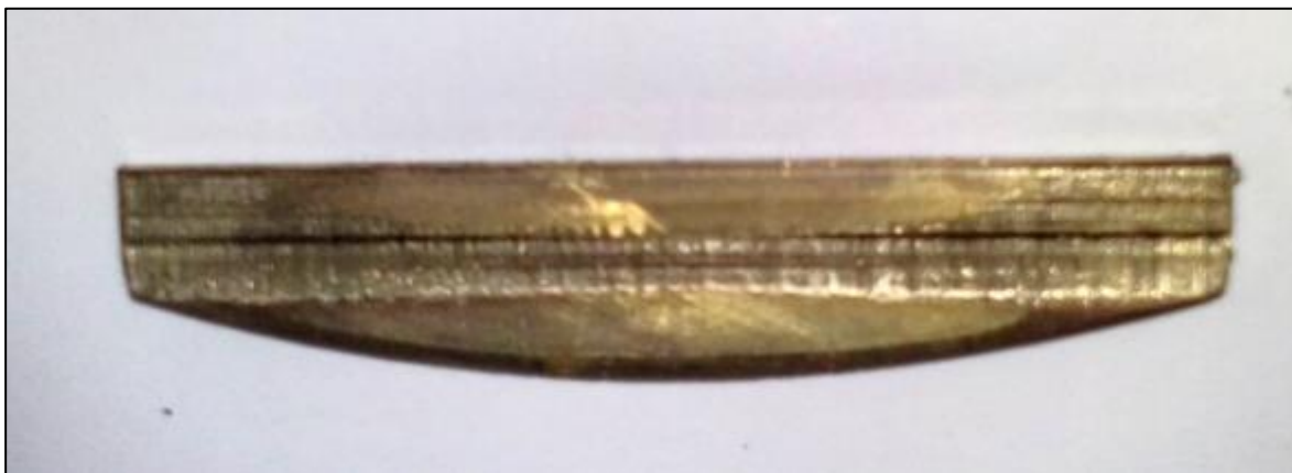
Figura 6-14: segni marcati dell'usura del fianco della paletta.
