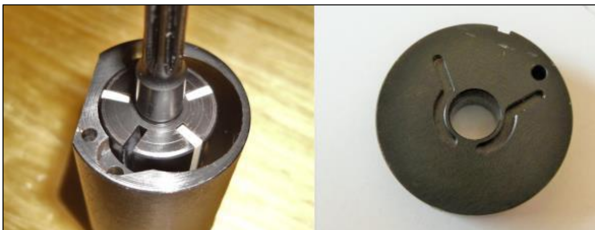
Figura 3-9: evidenza della rastrematura delle palette (a sinistra) e vista del coperchio di chiusura (a destra).
