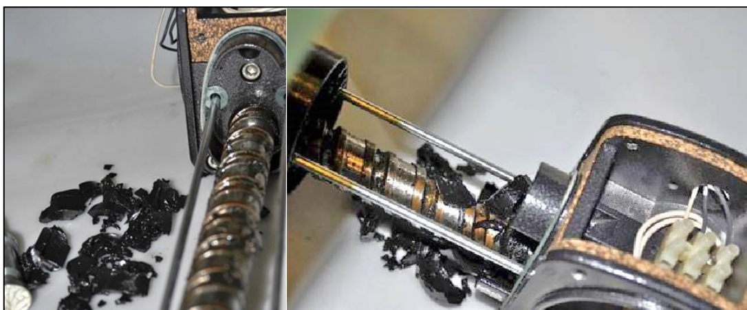
Figura 2-1: motori elettrici danneggiati dalle radiazioni (dose con beam-off di 1700 \mu\text{Sv/h} , dose totale per il cambio del motore di 875 \mu\text{Sv} ).
