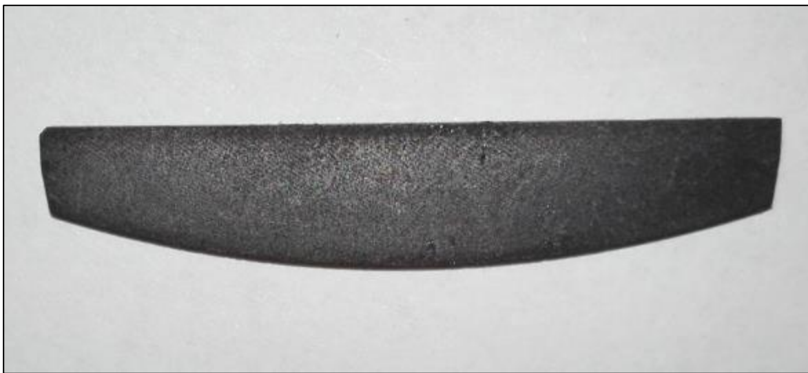
Figura 6-1 :paletta del motore pneumatico in grafite.
