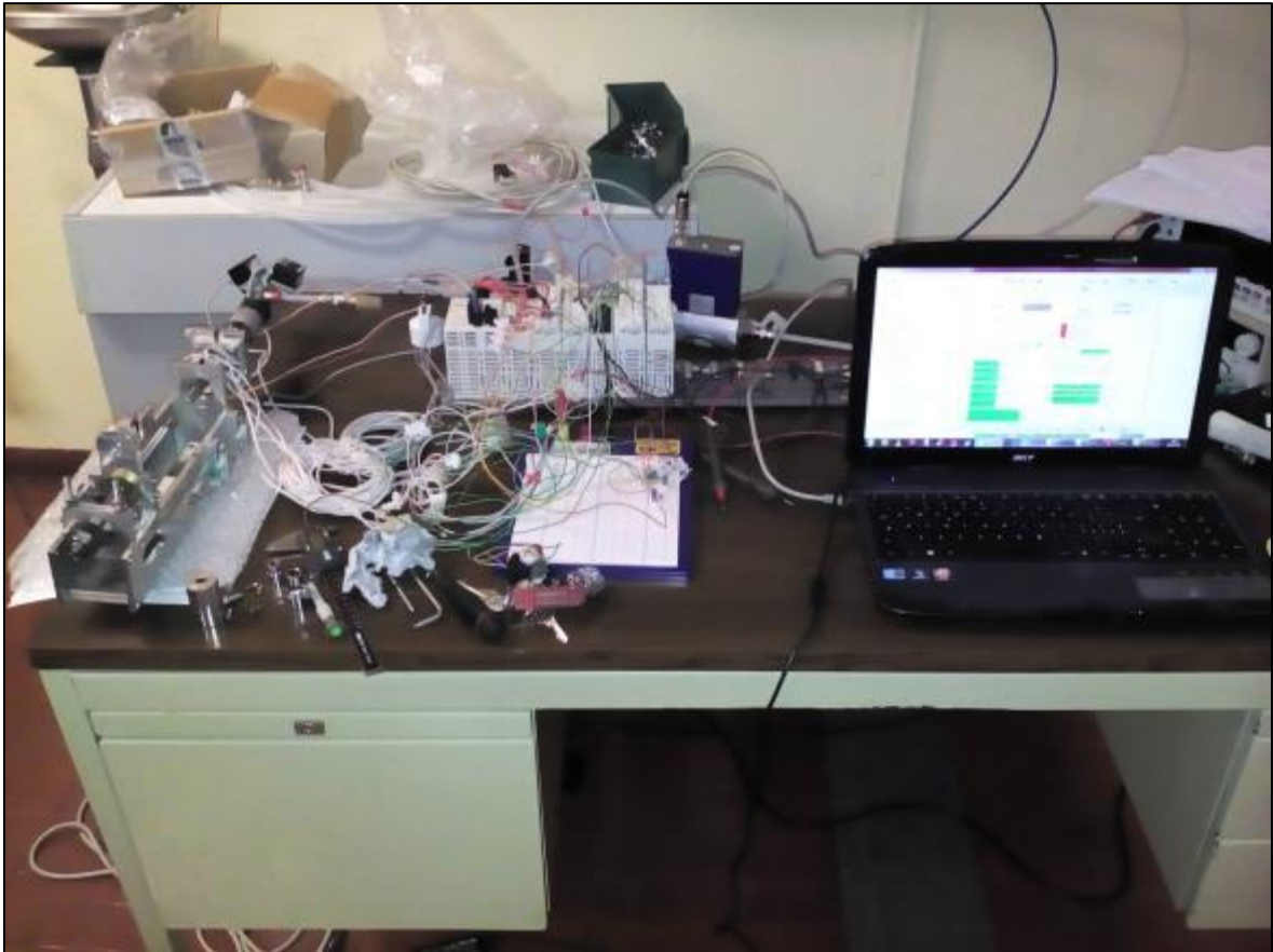
Figura 6-5: allestimento della prova, si noti la breadboard con il circuito amplificatore.
