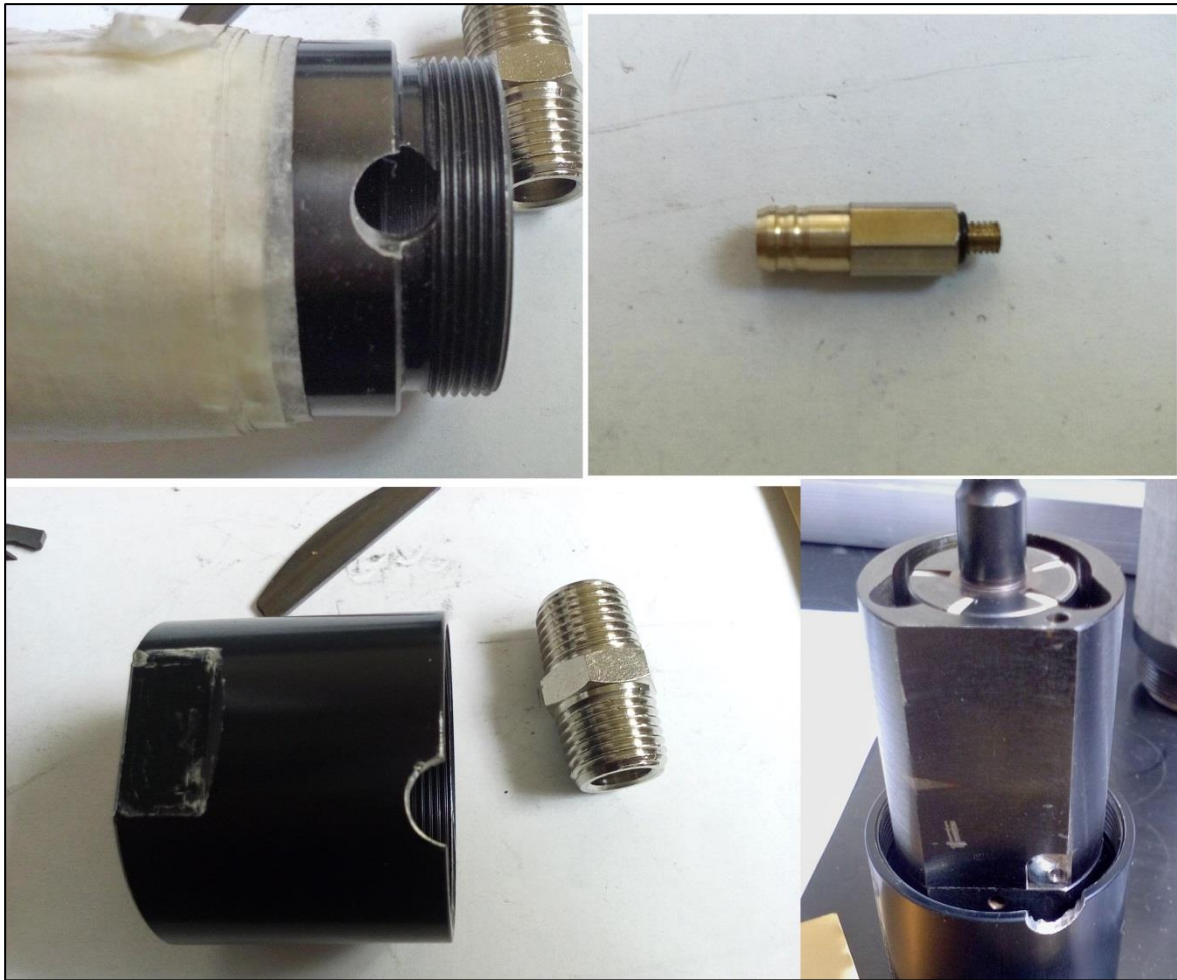
Figura 5-3: componenti modificati per la misura della pressione in camera.
