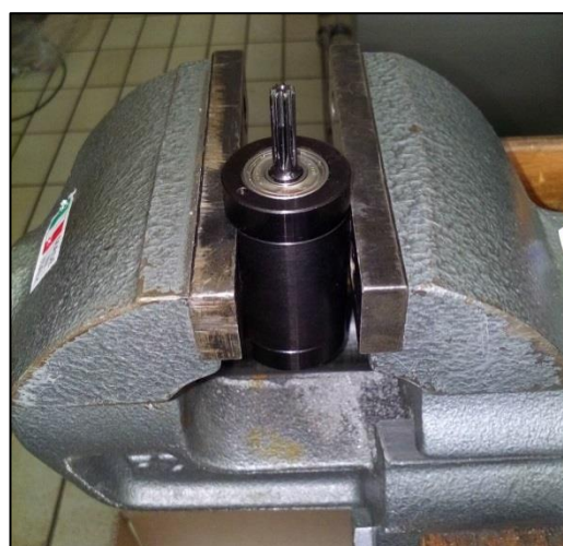
Figura C-10: posizionamento per lo smontaggio del coperchio di chiusura.
