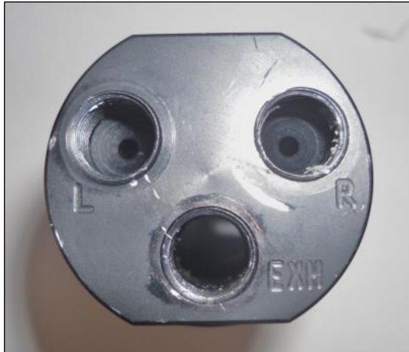
Figura 3-12: attacchi sul fondello per le prese d'aria (L,R) e lo scarico (EXH).
