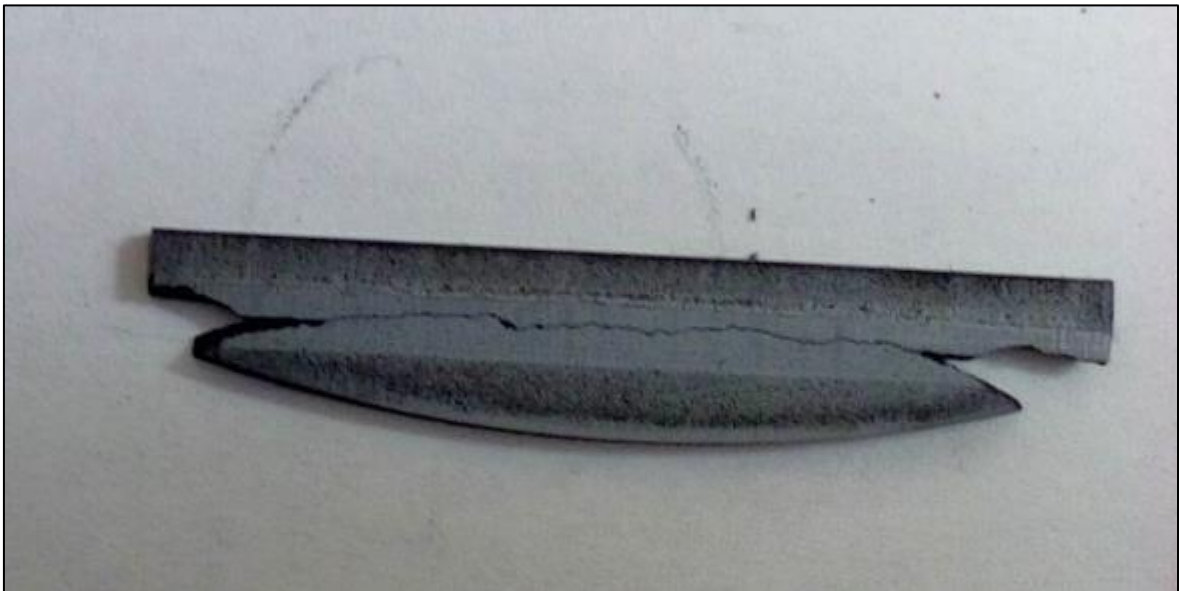
Figura 6-6 : zona di frattura di una delle palette rotte in grafite.
