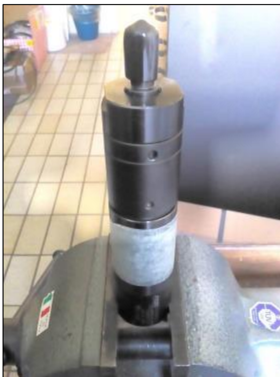
Figura C-8 : riduttore avvitato sul corpo cilindrico
