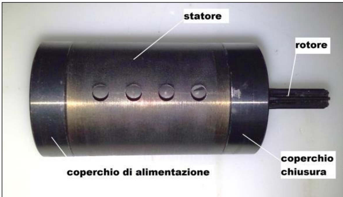
Figura 3-4 : parti principali del motore.
