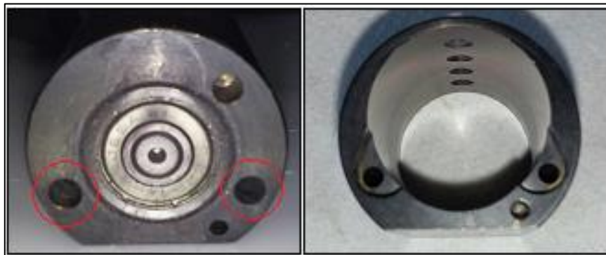
Figura 3-5 : fori coperchio di alimentazione (a sinistra) e corrispondenti sullo statore (a destra).
