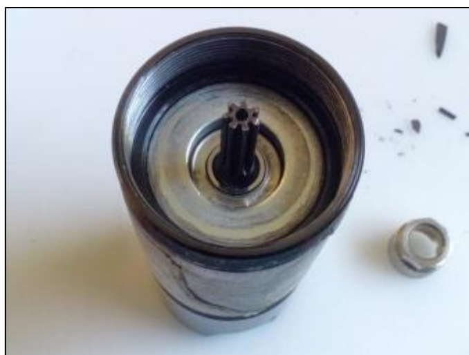
Figura C-7 : rosetta distanziatrice collocata in posizione.
