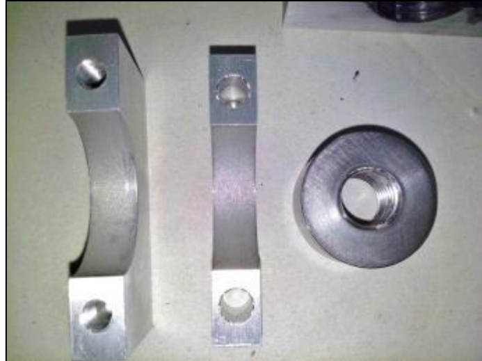
Figura 4-17 : pezzi del freno.
