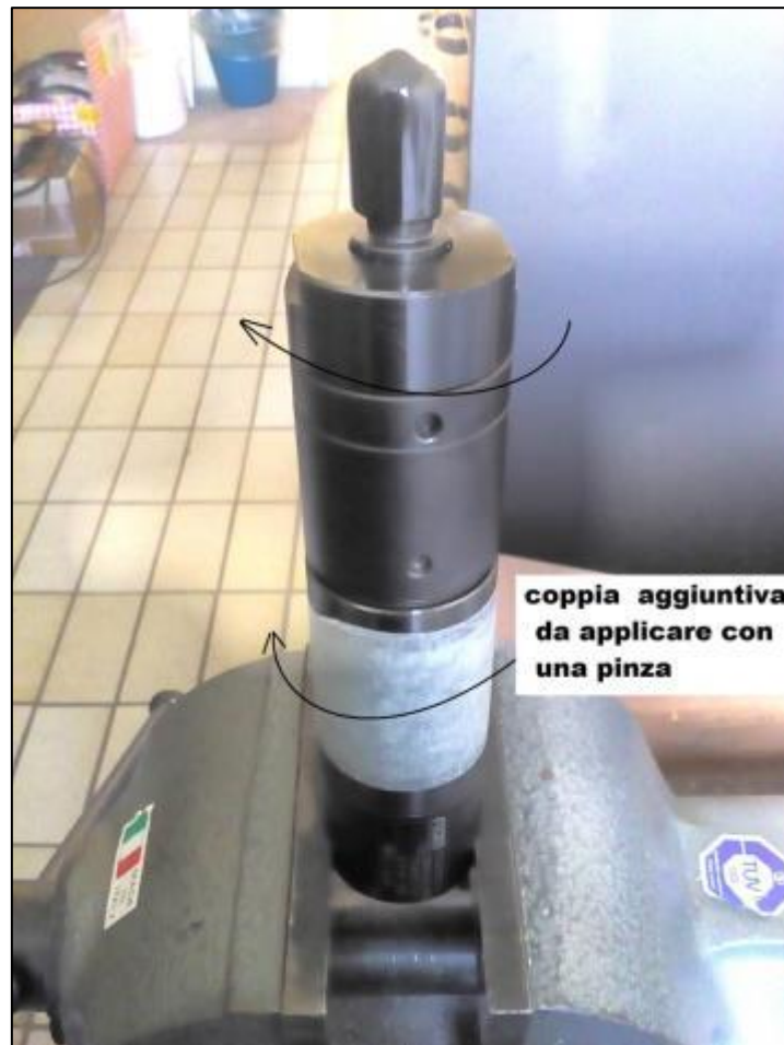
Figura C-9 : accorgimento durante lo smontaggio del riduttore.
