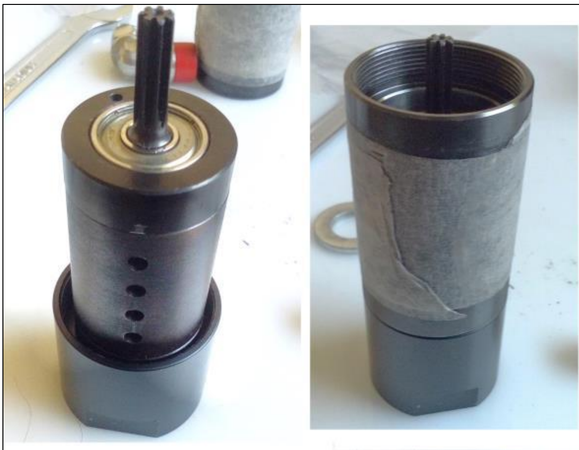
Figura 3-13: posizionamento del cuore del motore sul fondello e corpo cilindrico avvitato.
