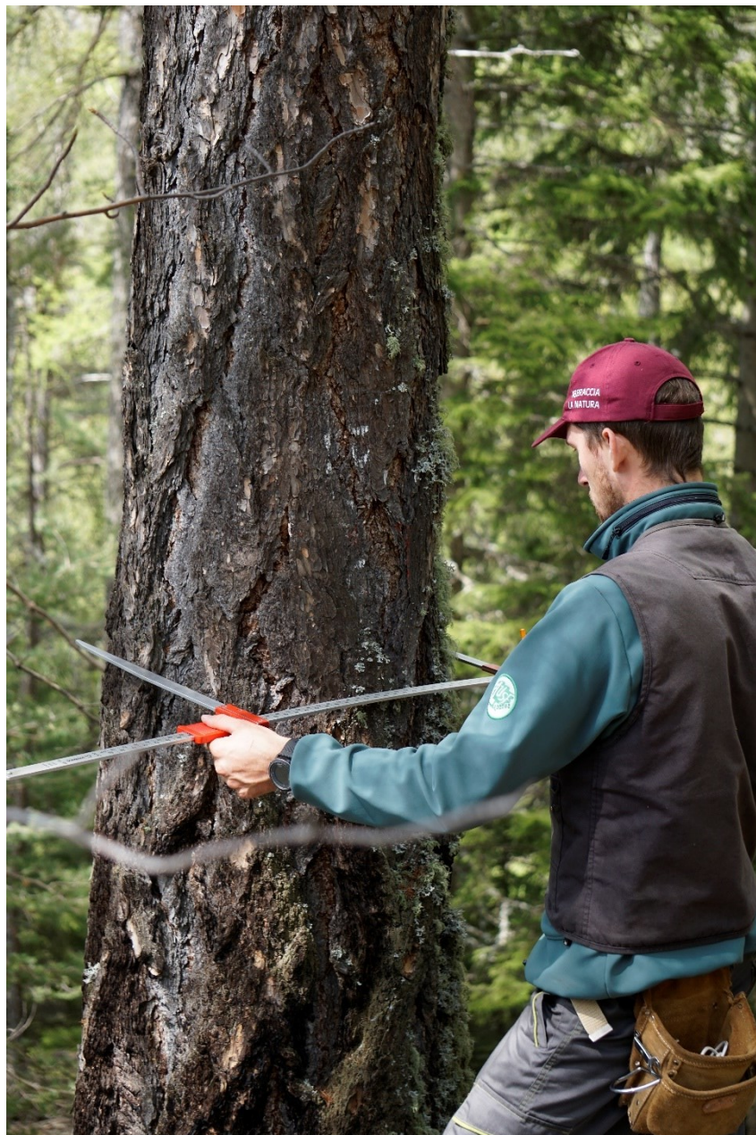
Figura 14 Rilievo del DBH con cavalletto forestale
