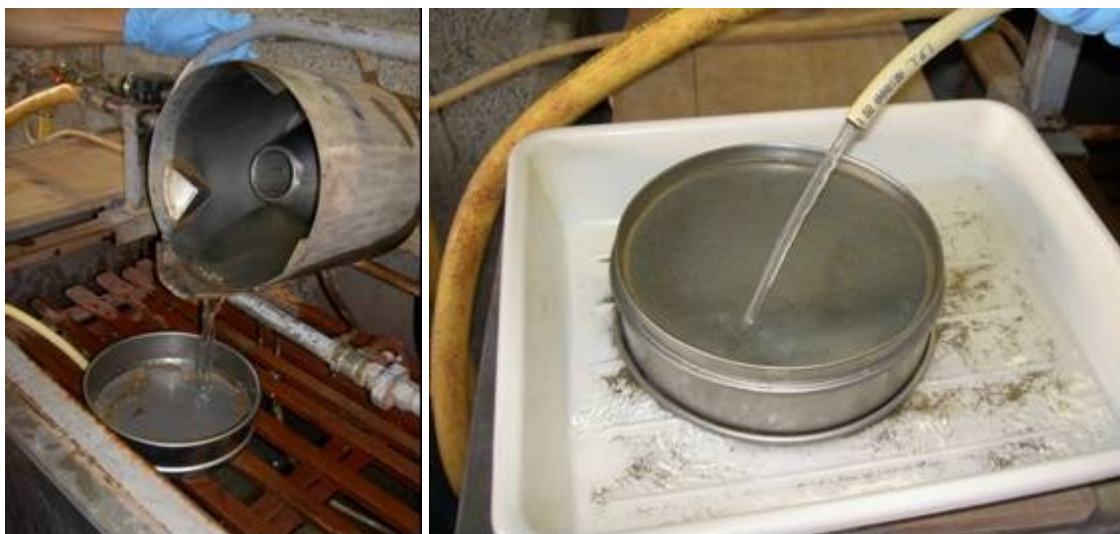
Figura 5. Fasi di svuotamento della centrifuga e del setaccio.
