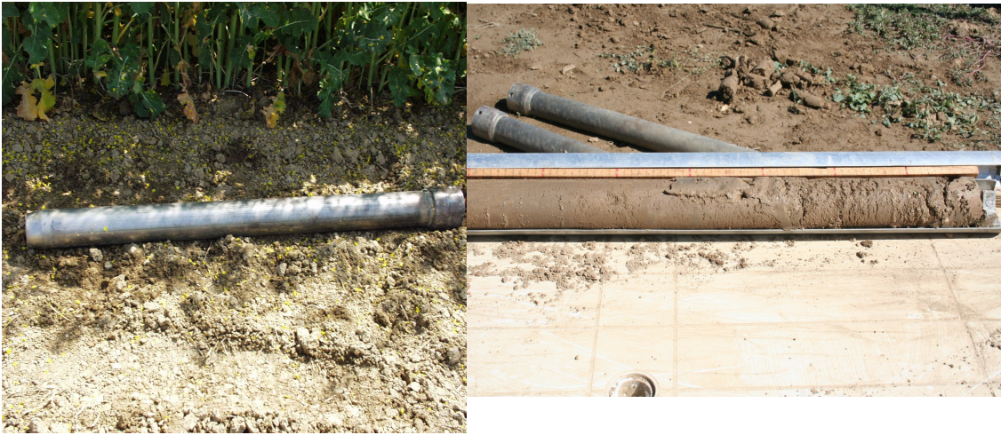
Figura 2. Carotiere dall'esterno e semi-cilindro interno con campione di terreno.
