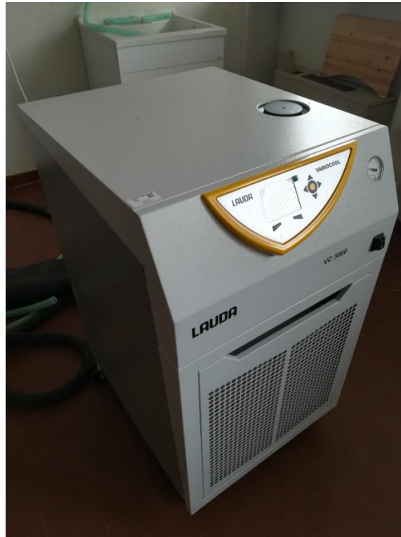
Figura 3.15: Chiller Lauda VC 3000, per l'alimento del circuito secondario al post condensatore.
