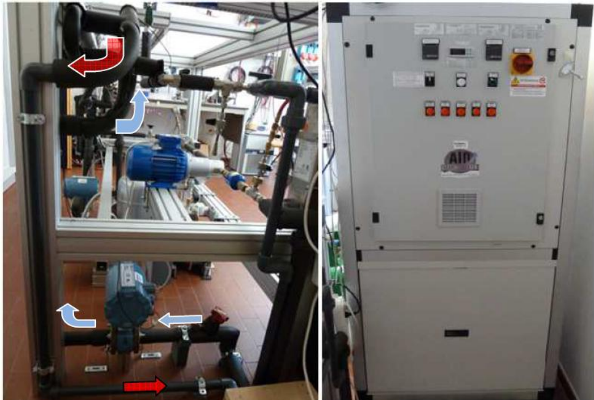
Figura 3.13: Circuito secondario per l'alimento del precondensatore. A destra si può notare il sistema di regolazione della temperatura tramite il quale è regolabile il titolo di vapore prima dell'ingresso nella sezione di prova [7]
