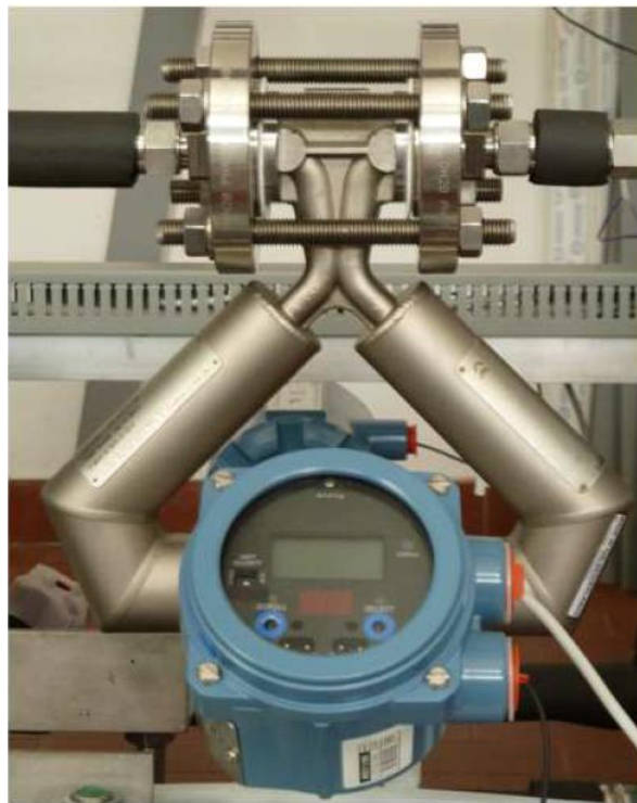
Figura 3.7: Misuratore di portata ad effetto Coriolis. [7]
