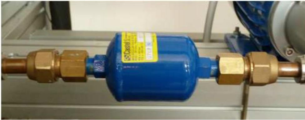
Figura 3.4 : Filtro “Castel serie 4303” installato nel circuito [7]
