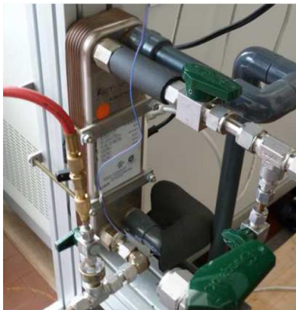
Figura 3.11: Post condensatore a piastre alimentato ad acqua [7]
