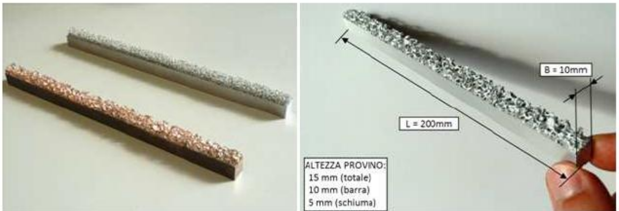
Figura A.4.1: Schiume metalliche utilizzate e dimensioni geometriche [7]
