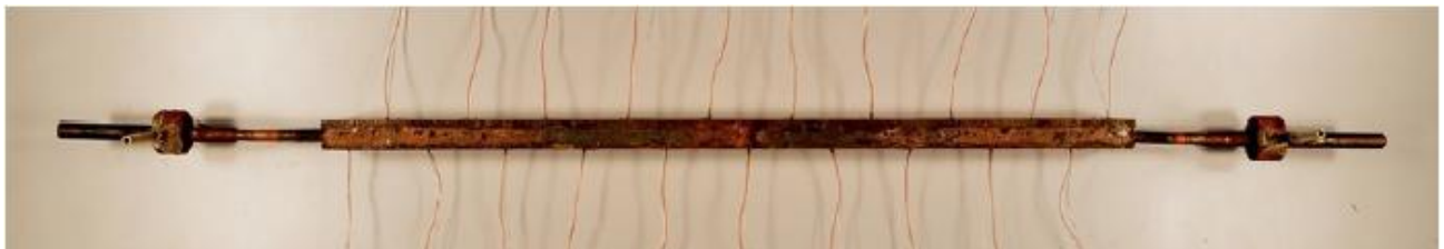
Figura 4.1: Sezione microfin in fase di assemblaggio [8]
