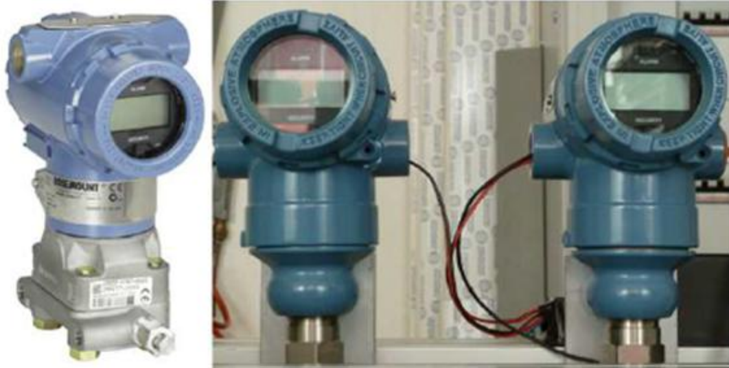
Figura 3.17: Misuratore di pressione differenziale (a sinistra) installato per la misura delle perdite di carico nella sezione di prova e due misuratori assoluti di pressione (a destra)[7]
