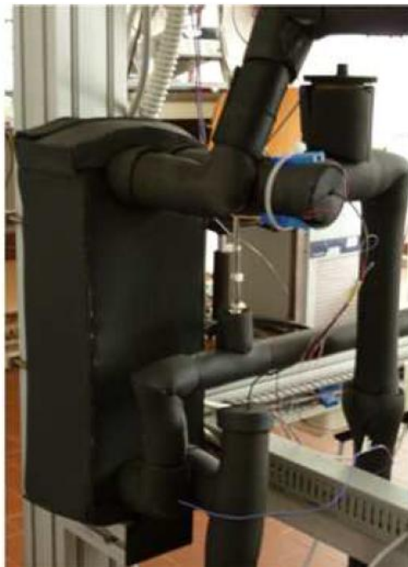
Figura 3.9: Evaporatore a piastre in controcorrente [7]
