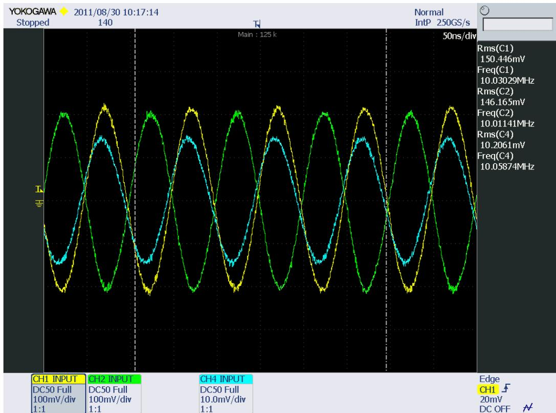
Fig. 7.11 – Schermata dell'oscilloscopio con misura a 10 MHz e scala dei tempi pari a 50 ns/div.
