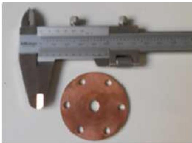
Fig. 6.9 – Foto del campione di prova, vista sul deposito in rame
