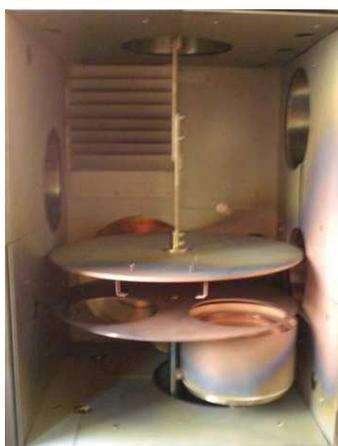
Fig. 6.4 - Interno della camera di sputtering [33]
