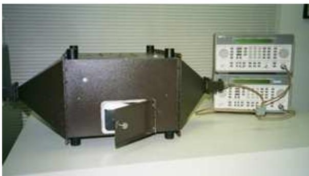
Fig. 3.1 - Esempio di cella TEM a sezione rettangolare [18]
