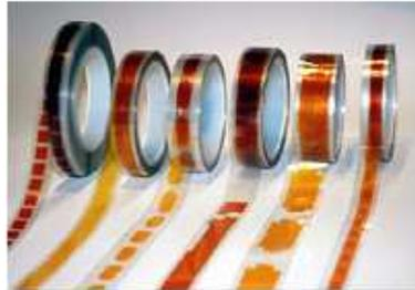
Fig. 6.10 - Diversi esempi di nastro realizzato in Kapton ® [30]
