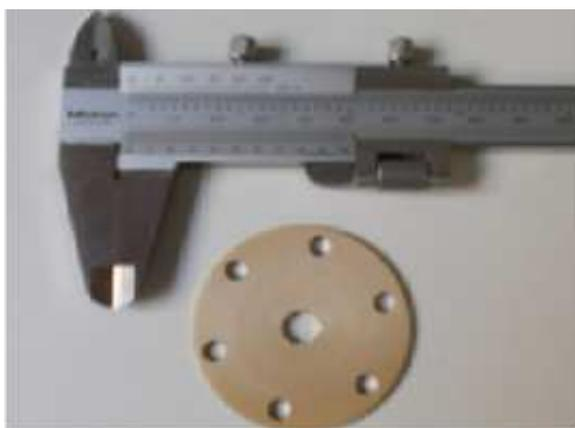
Fig. 6.7 – Foto del substrato in peek utilizzato per la realizzazione dei due schermi
