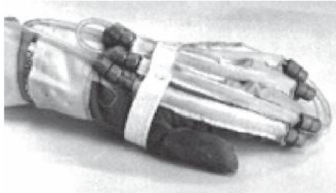
**Fig. 13.** Guanto in lega a memoria di forma con fili in nitinolo in conformazione martensitica (da [5]).
