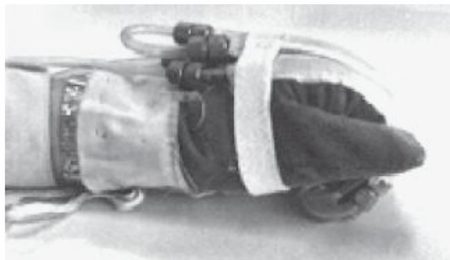
**Fig. 14.** Guanto in lega a memoria di forma con fili in nitinolo in conformazione austenitica (da [5]).
