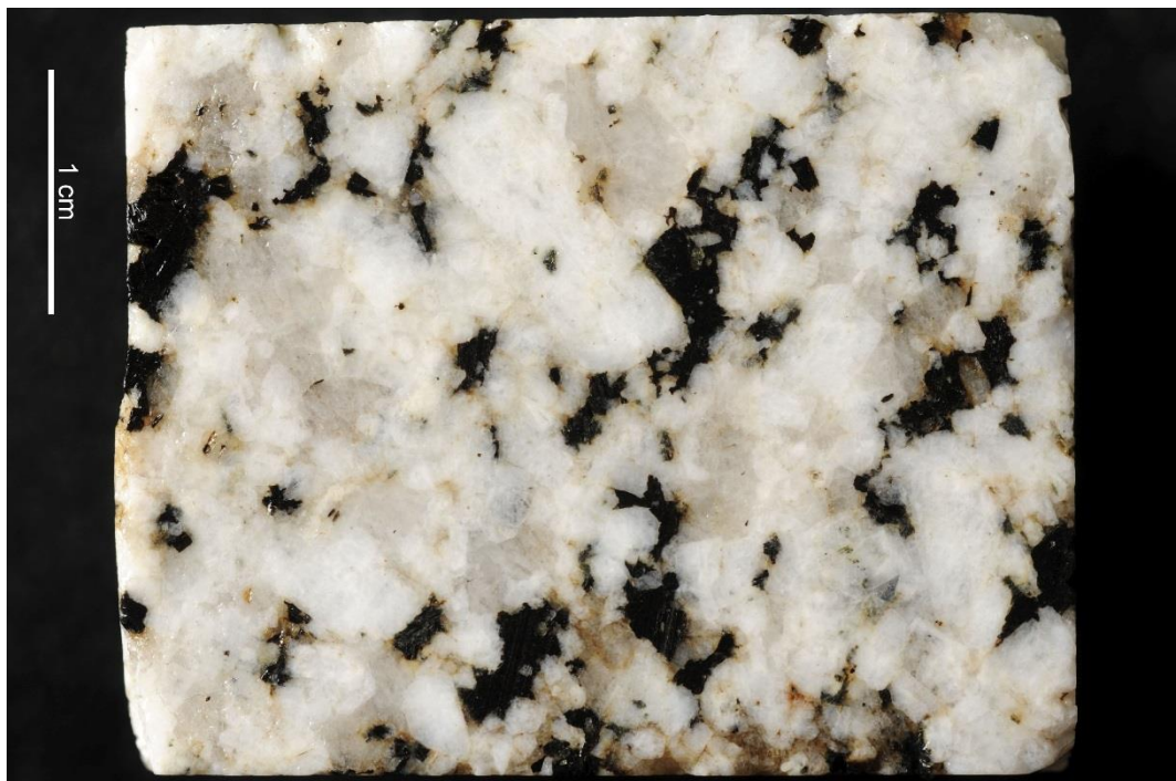
Figura 45. Campione CAL 32.4. Granodiorite proveniente da Soverato (IT).
