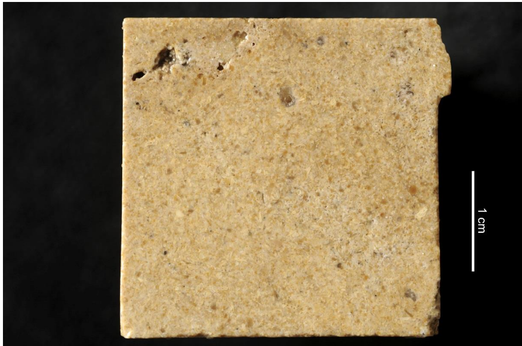
Figura 52. Campione AG 40. Calcarenite proveniente da San Vito Lo Capo (IT).
