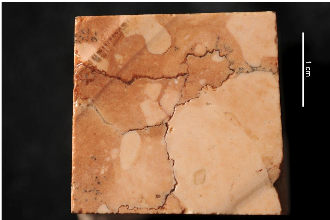
Figura 63. Campione I 04.1. Calcare rosso proveniente da Cerro Veronese (IT), formazione del Rosso Ammonitico Veronese.
