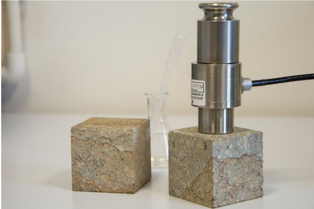
Figura 7. Il sensore dello TCi durante una misura su un provino di trachite.
