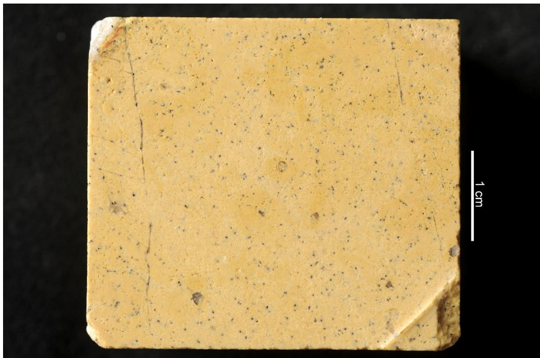
Figura 57. Campione G 9.1. Marna proveniente da Palù di Giovo (IT), formazione del Werfen, orizzonte di Andraz.
