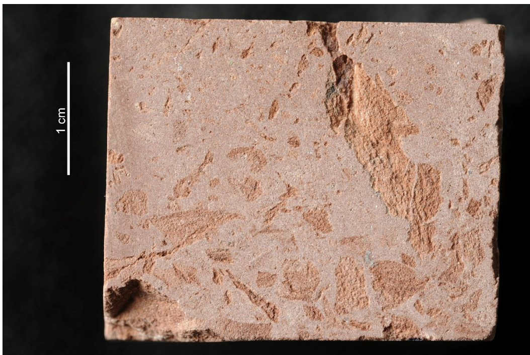
Figura 58. Campione G 9.4. Marna proveniente da Palù di Giovo (IT), formazione del Werfen, orizzonte di Andraz.
