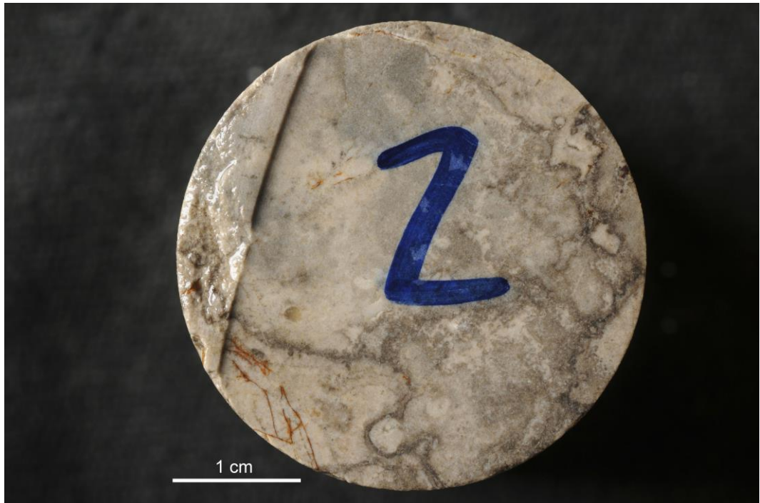
Figura 36. Campione 1632 33 VR. Calcare mamoso massivo proveniente da Newbridge (IR), formazione di Waulsortion.
