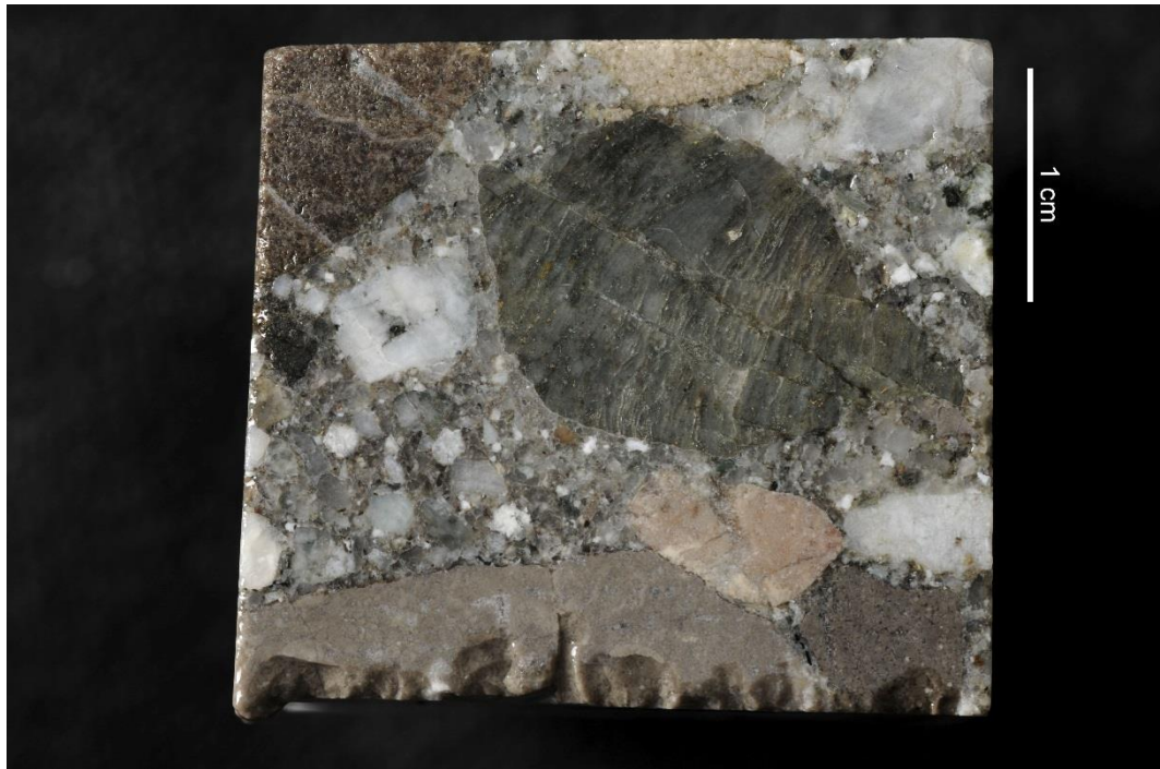
Figura 48. Campione NA 34.2. Conglomerato con clasti prevalentemente carbonatici proveniente da La Retara (IT).
