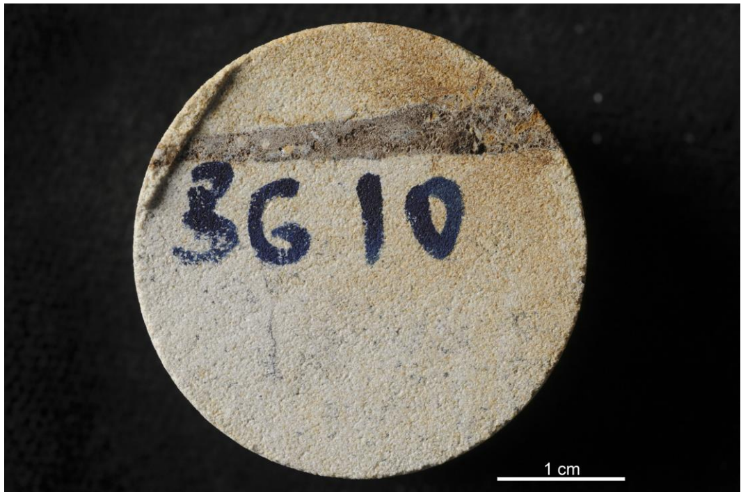
Figura 32. Campione BG 10 A. Wackestone proveniente da Drogheda (IR), formazione di Crufty.
