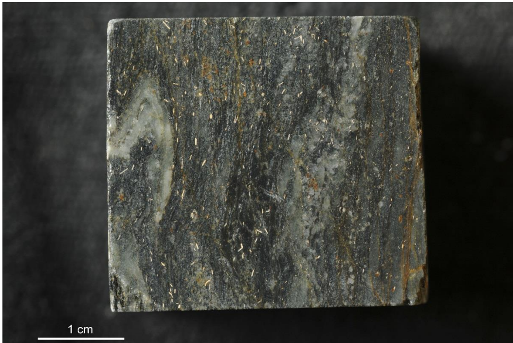
Figura 54. Campione G 2.3. Fillade proveniente da Madrano di Pergine Valsugana (IT), formazione delle filladi quarzifere della Valsugana.
