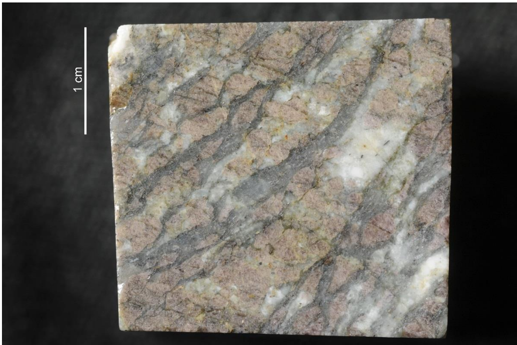
Figura 43. Campione CAL 25.1. Gneiss a granato, biotite e sillimanite proveniente da Rende (IT).
