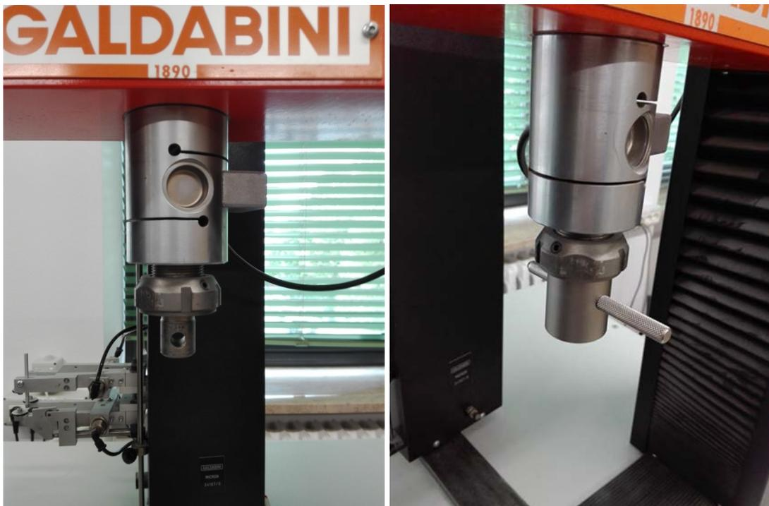
**Figura 86: Sistema di attacco: cella di carico e perno di collegamento a sinistra, boccola e spina a destra.**
