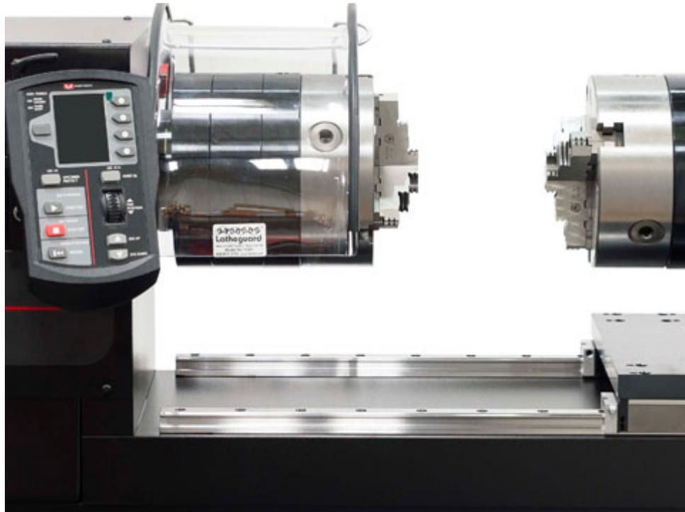
**Figura 29: Macchina Instron serie MT per carichi medi.**
