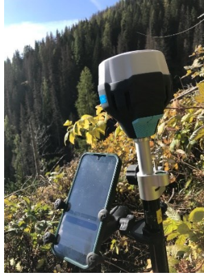
Figura 3.8 Ricevitore GNSS utilizzato per l'acquisizione dei GCP nell'area Franza (2019)
