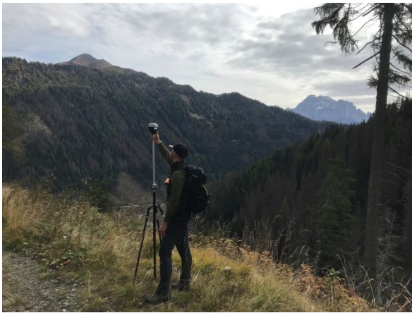
Figura 3.9 Posizionamento del ricevitore base GNSS per la correzione della misurazione in tempo reale nell'area Franza (2019)
