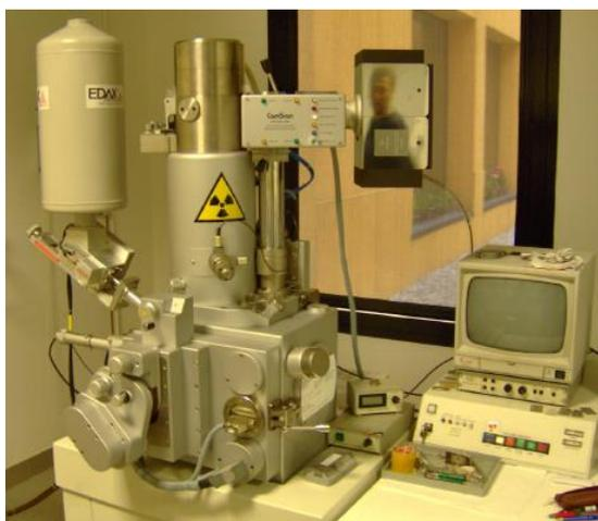
**Fig. 3.4** – Microscopio elettronico a scansione in dotazione al Dipartimento di Geoscienze dell'Università di Padova.
