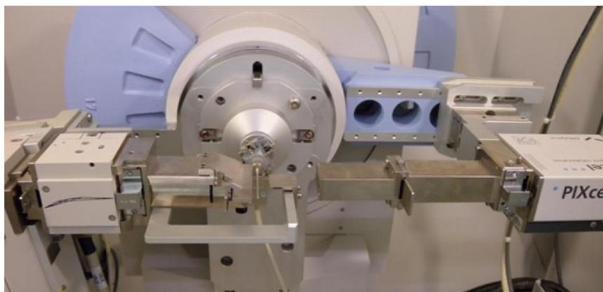
**Fig. 3.2** – Diffratometro PANalytical X'Pert PRO in geometria Bragg-Brentano in modalità  $\theta$ - $\theta$  in trasmissione, in dotazione al Dipartimento di Geoscienze dell'Università di Padova.
