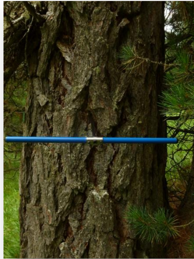
Figura 3.2: Esempio di Succhiello di Pressler durante una fase di carotaggio. Fonte: Michela Censi
