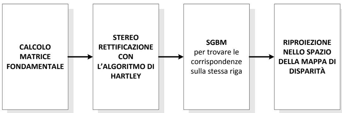
Figura 4.13: *Continuazione del diagramma di flusso della Structure From Motion nel caso in cui non si utilizzano i parametri intrinseci.*
