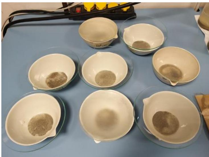
*Figura 8.2.2: Foto delle ciotole con i campioni essiccati in forno dopo circa 12 ore.*
