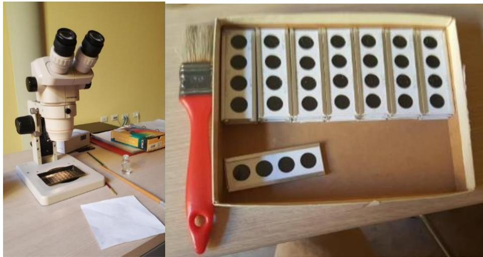
*Figura 8.3.1 (sinistra) e 8.3.2 (destra): A sinistra la foto del microscopio ottico con luce e piattello amovibile per l'individuazione degli esemplari, a destra la foto delle slides contenenti gli esemplari selezionati di *Uvigerina peregrina*.*
