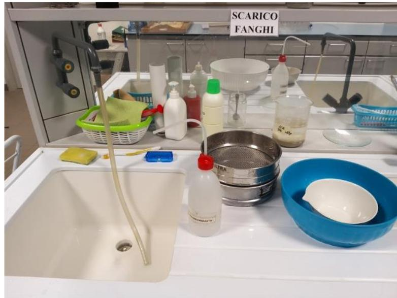
*Figura 8.2.1: Foto della postazione di lavaggio, con setacci, acqua deionizzata e ciotola in porcellana, presso il laboratorio di micropaleontologia del Dipartimento di Geoscienze.*
