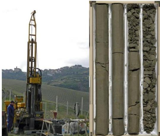
*Figura 2.2.7: A sinistra: panoramica sull’abitato di Crosia con, in primo piano, il sito di perforazione. A destra: aspetto dei segmenti sommitali della carota PCS; ogni “spezzone” è lungo 1 m. La parte frammentata corrisponde al regolite (da Reghellin, 2010).*
