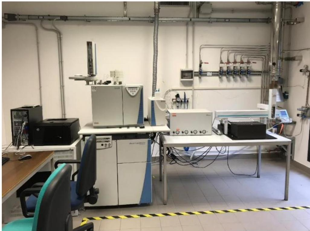
Figura 8.6.1: Foto dell'IRMS (Isotope Ratio Mass Spectrometer) Thermo Scientific Delta V Advantage del Dipartimento di Geoscienze, Università di Padova.
