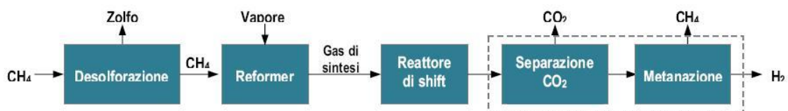
Figura 5: Diagramma di flusso semplificato di un impianto per la produzione di idrogeno per reforming del metano
