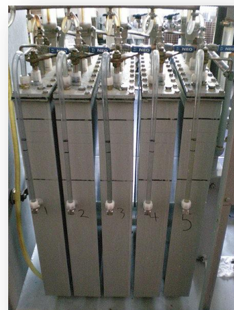
Figura 4: Celle per l'elettrolisi dell'acqua
