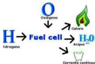
Figura 25: alimentazione e produzione di una fuel cell
