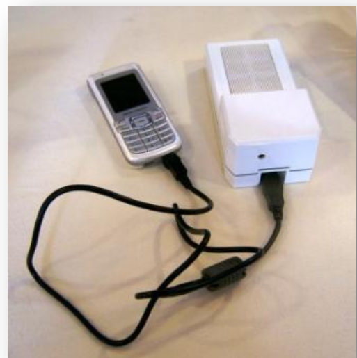
Figura 37: Cella a metanolo diretto per l'alimentazione del cellulare
