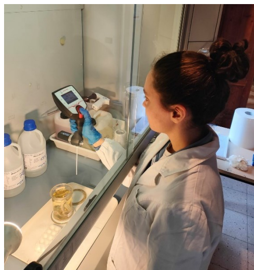
Figura 10. Titolazione di un liquido di dimora idroalcolico con alcolometro di precisione.
