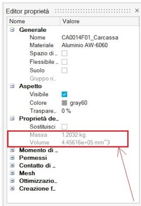
Figura 6.35: Massa della carcassa ottenuta per la configurazione sedici alette
