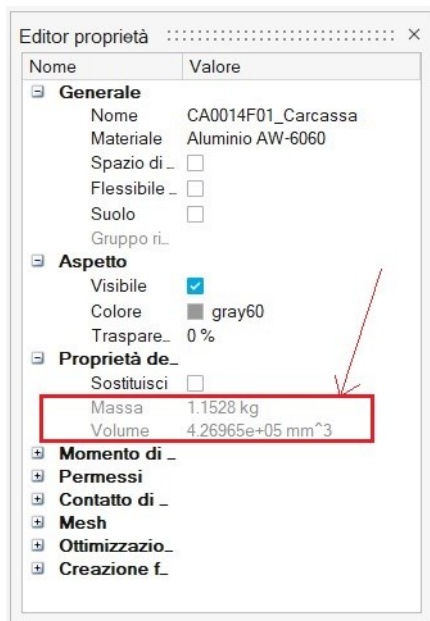
Figura 6.13: Massa della carcassa ottenuta per la configurazione numero di alette minimo
