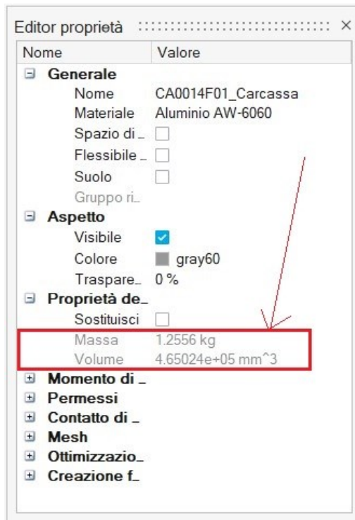
Figura 6.57: Massa della carcassa ottenuta per la configurazione ventisei alette
