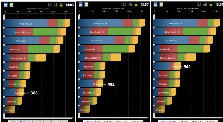
Figura 5.2: Gingerbread su SD: risultati del benchmark Quadrant a diverse frequenze (700MHz, 900MHz, 1100MHz).
