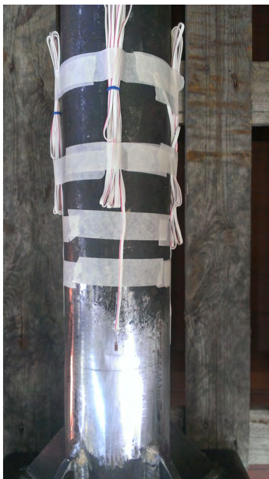
Figura 7.17: Vista della zona estensimetrata nel veicolo.
