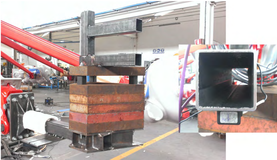
Figura 3.26: Fissaggio dell'accelerometro nella zona del veicolo tramite del nastro biadesivo. Si noti nella parte sinistra dell'immagine la presenza della staffe su cui fissare lo strumento per un corretto posizionamento.
