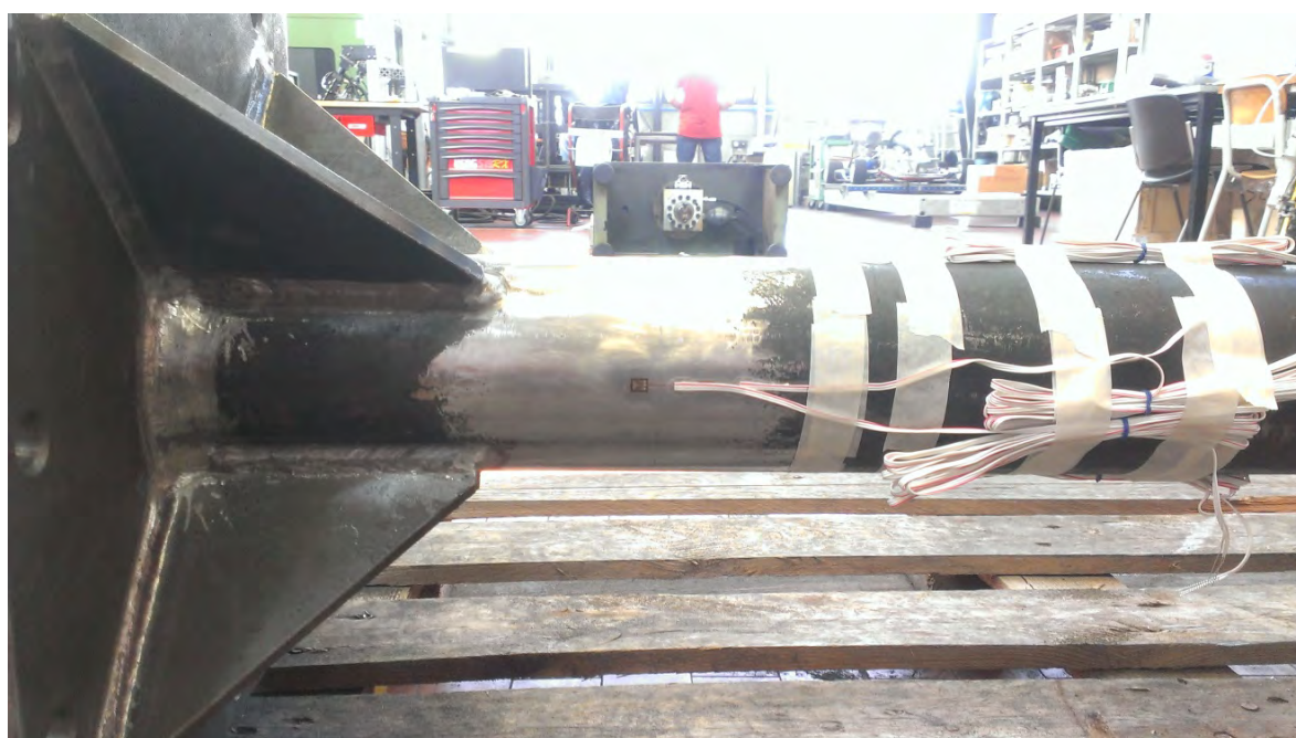
Figura 7.18: Lato superiore della zona del zona veicolo: si noti la presenza della rosetta estensimetrica e di un estensimetro a griglia singola.
