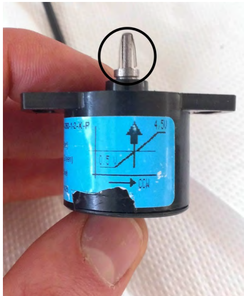
Figura 3.27: Sensore di Hall utilizzato per monitorare l'inclinazione del braccio principale della giostra.
