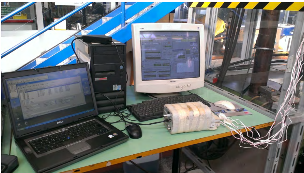
Figura 11.19: Computer usato per controllare la macchina MFL, centralina Cronos e pc portatile usato per controllarla.
