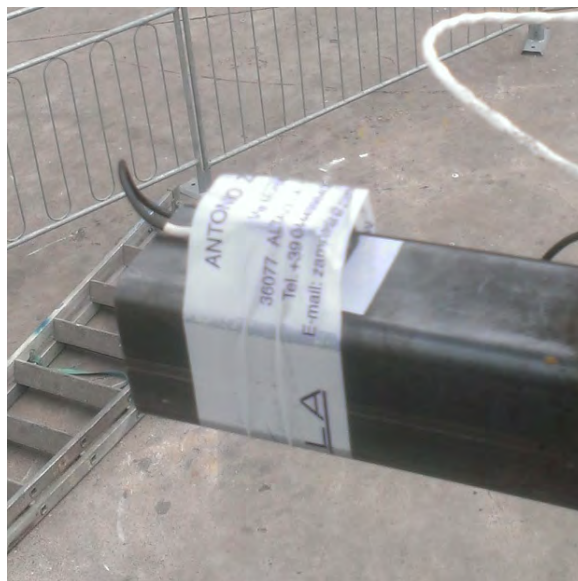
Figura 7.12: Fissaggio dell'accelerometro nella zona del veicolo.
