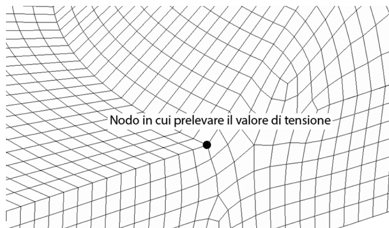
Figura 12.13: In figura è indicato il nodo in cui prelevare il valore di tensione per applicare il metodo PSM.
