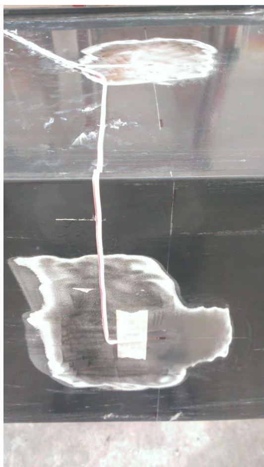
Figura 7.26: Esempio di disposizione dei cavi nella zona estensimetrata.
