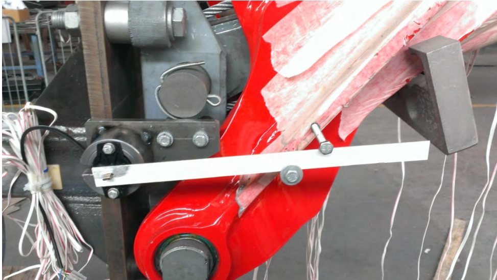
Figura 3.28: Sensore di Hall ed asta di collegamento al braccio principale della giostra.
