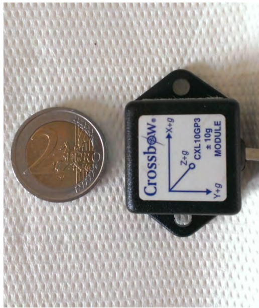
Figura 3.25: Accelerometro a 3 assi utilizzato durante le prove. Per il fissaggio è stato utilizzato del nastro biadesivo posto nella parte inferiore dello strumento.
