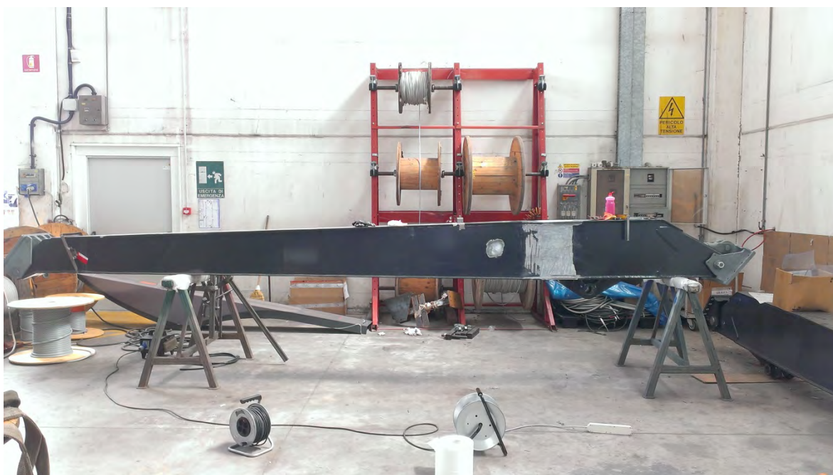
Figura 7.21: Braccio principale della giostra durante il lavoro di estensimetrazione.
