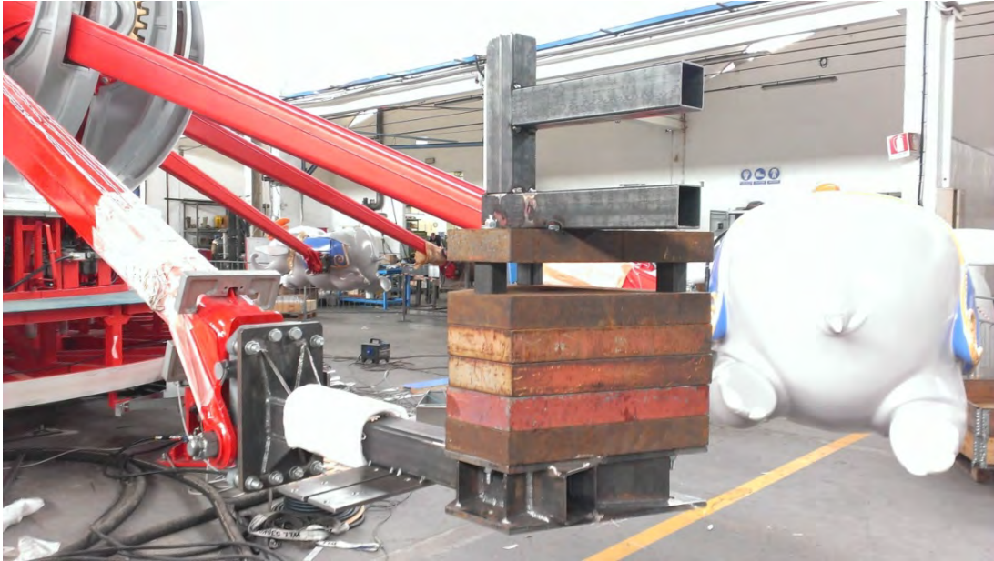
Figura 3.36: Zona del veicolo montata per effettuare le prove. Si noti la presenza delle due staffe di supporto per le centraline.
