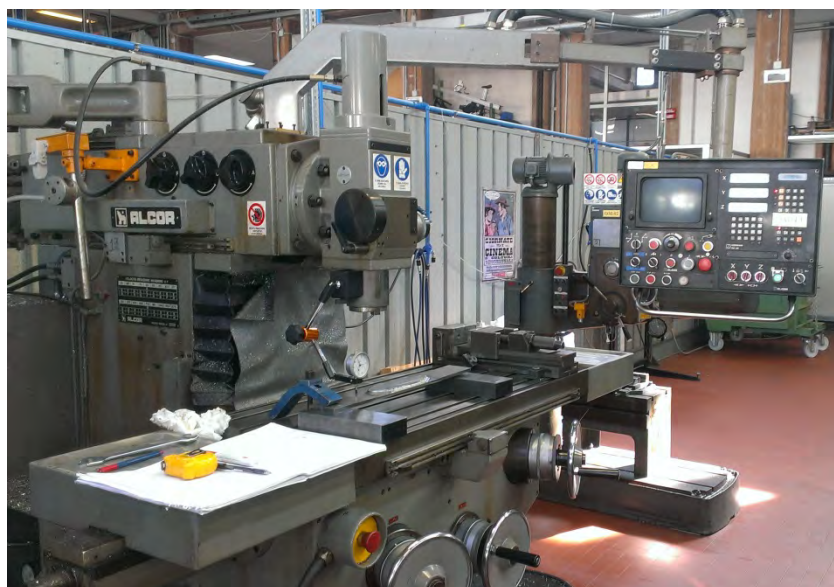
Figura 11.5: Macchina a controllo numerico utilizzata durante le rilevazioni. Si noti il comparatore bloccato sulla testa di lavoro della macchina.
