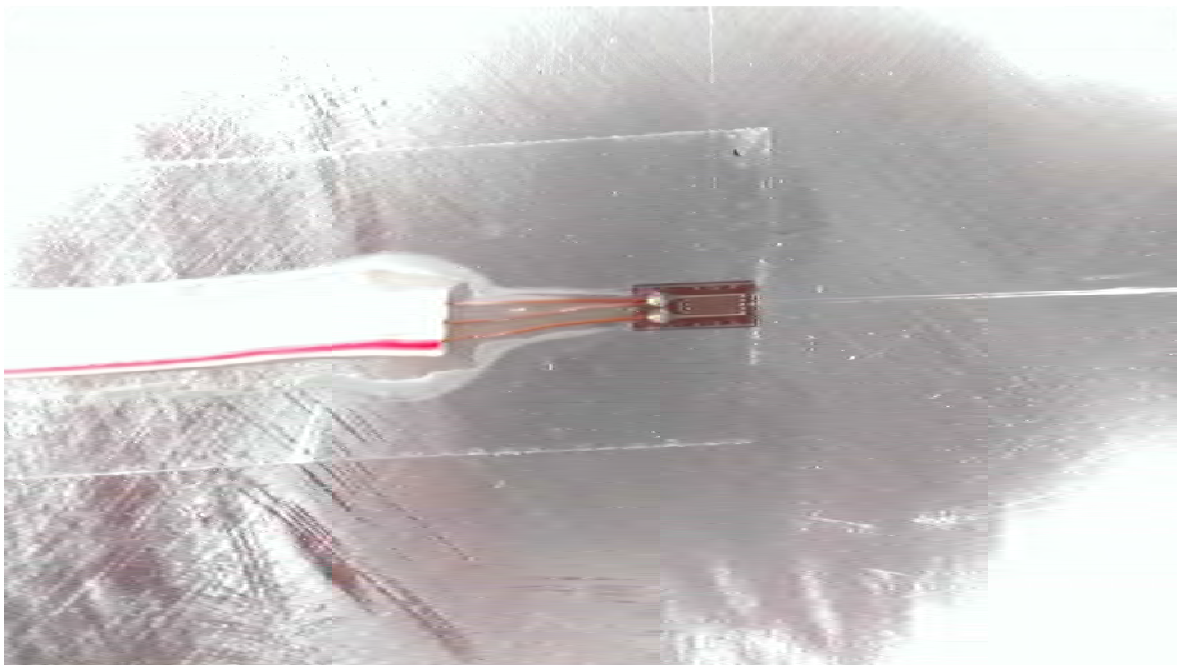
Figura 7.24: Dettaglio dell'estensimetro incollato nella faccia superiore del braccio
