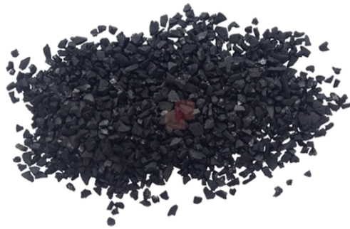
Figura 7: Carbone attivo in granuli
