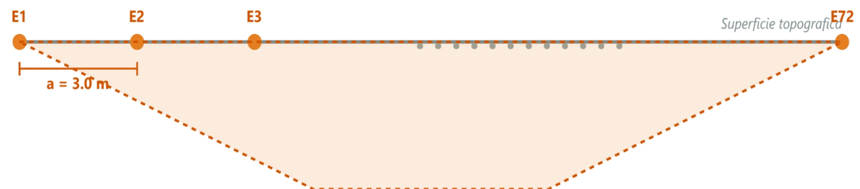
Configurazione ERT: Spaziatura Ampia (3.0 m)
