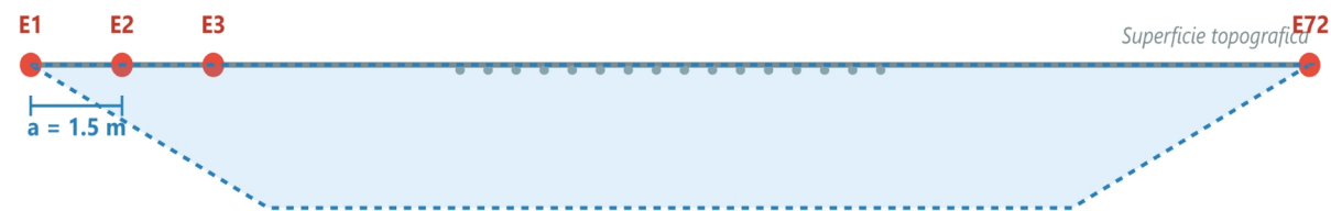
Configurazione ERT: Spaziatura Stretta (1.5 m)
