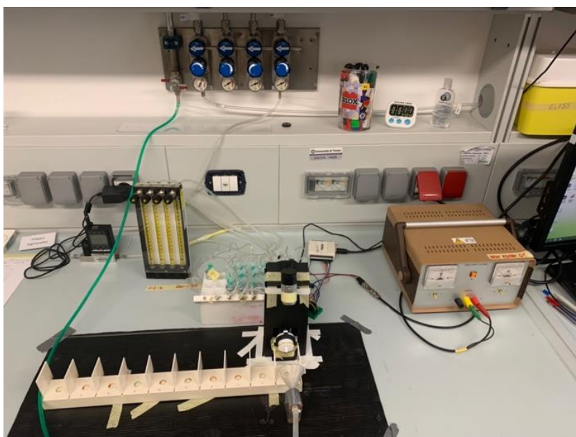
(Fig. 8) Apparato sperimentale composto da: computer; alimentatore di corrente; valvole di apertura dell'aria; regolatore di pressione dell'aria; Arduino per il controllo delle valvole tramite il programma MatLab , batteria degli odori, tubo di aspirazione, pedana sperimentale per il posizionamento dei soggetti.
