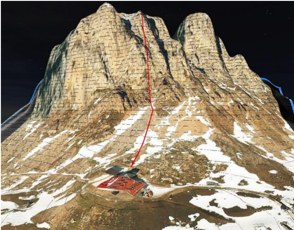
Fig.30 - traiettoria di caduta massi considerata per la simulazione in rosso
