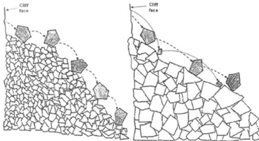
Fig. 16 – Perdita di energia in funzione del rapporto tra i volumi in un pendio di detrito (Giani, 1992).
