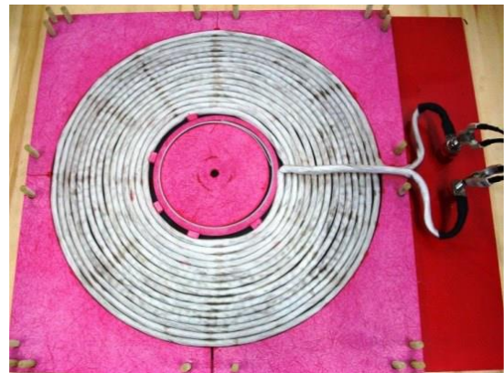
Figura 2.6 - rappresentazione del sistema bobine – ferrite e foto di una bobina realizzata
