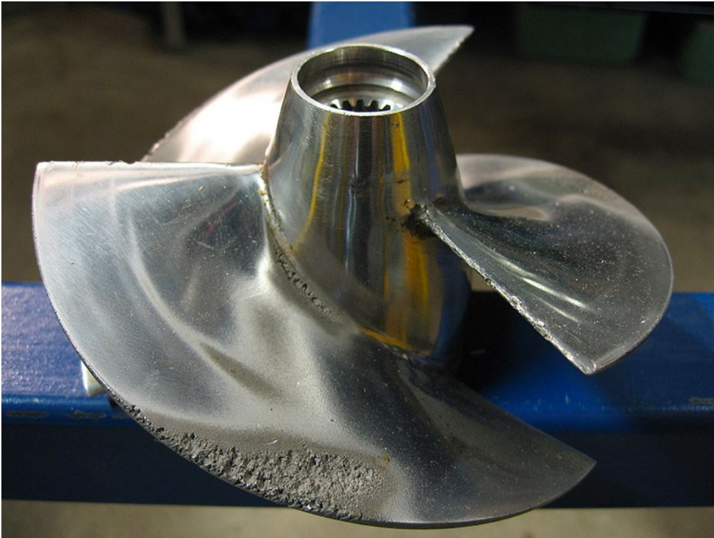
Figura 3.7 – Danni della cavitazione sulle pompe
