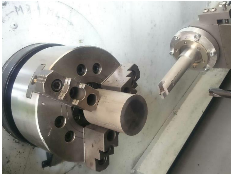
Figura 3.1: Setup sperimentale per tornitura ad ultrasuoni.
