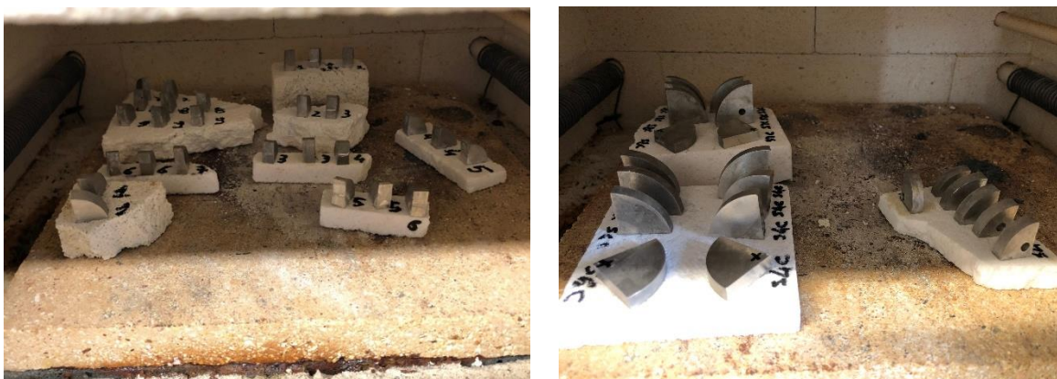
Figura 5.6: disposizione campioni in forno per la sinterizzazione.
