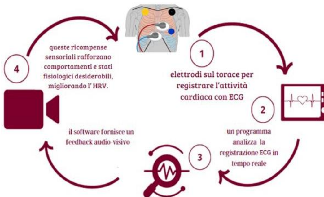
Figura 2.12: fasi del processo di biofeedback su HRV. Innanzitutto, la procedura inizia con il posizionamento dei sensori HRV sul corpo, con l'obiettivo di rilevare l'attività cardiaca, rappresentata tramite l'intervallo tra i battiti cardiaci, che viene amplificata e filtrata per eliminare i rumori di fondo. I segnali analogici rilevati dai sensori vengono convertiti in dati digitali tramite un convertitore analogico-digitale. Successivamente, un programma analizza i dati digitalizzati in tempo reale, identificando specifici pattern di variabilità della frequenza cardiaca. Il software fornisce quindi un feedback audio-visivo al soggetto, aiutandolo a sviluppare abilità enterocettive per migliorare il controllo volontario del sistema nervoso autonomo, promuovendo uno stato di rilassamento e benessere.
