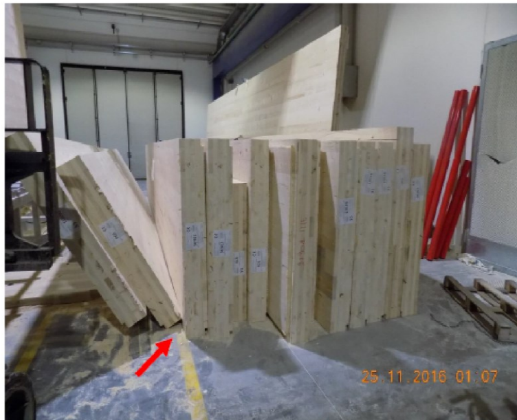
Figura 5.5. Pannelli 96903 e 968 all'interno della zona di transito e pali rossi amovibili non installati
