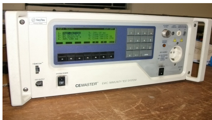
Fig. 2.22: Strumento utilizzato in laboratorio per eseguire la prova delle microinterruzioni e variazioni di tensione
