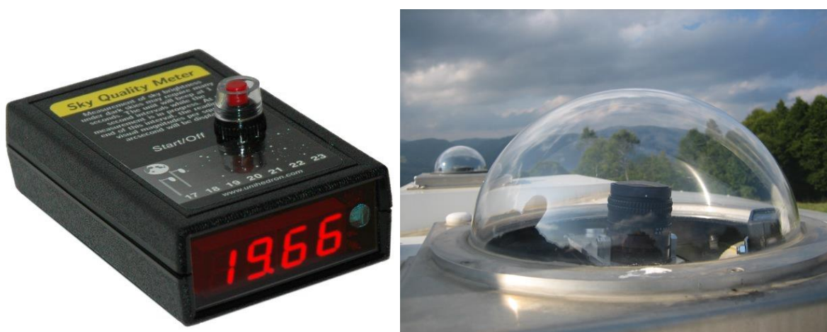
Fig. 6.1: a sinistra un esempio di SQM, a destra il posizionamento nella cupola della all-sky camera (tesi Vedovato 2013).
