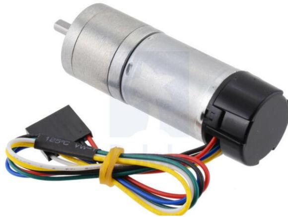
Figura 6.1: motore 12 VDC con motoriduttore 1:50 e con encoder rotativo, fornito da Pololu Corporation
