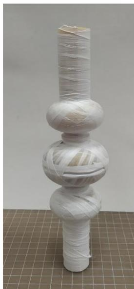
Figura 5.13: Anima in PVA ricoperta da Teflon. Questo rivestimento è necessario poiché il PVA viene intaccato dal solvente DMAc.
