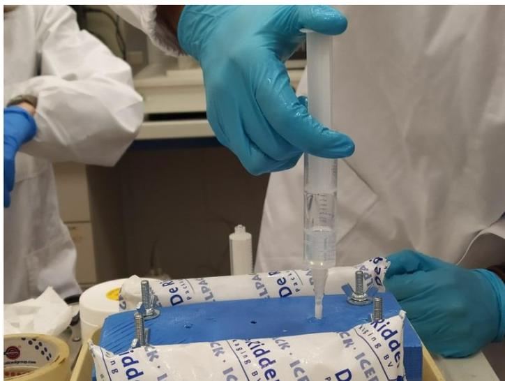
Figura 5.8: La colata di gomma siliconica è stata effettuata mediante l'utilizzo di siringhe graduate da 20 mL appositamente modificate; la temperatura attorno allo stampo è abbassata utilizzando delle sacche di ghiaccio.
