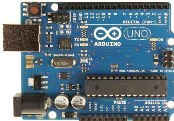
Figura 6.2: Scheda logica Arduino UNO utilizzato per gestire il controllo del motore.
