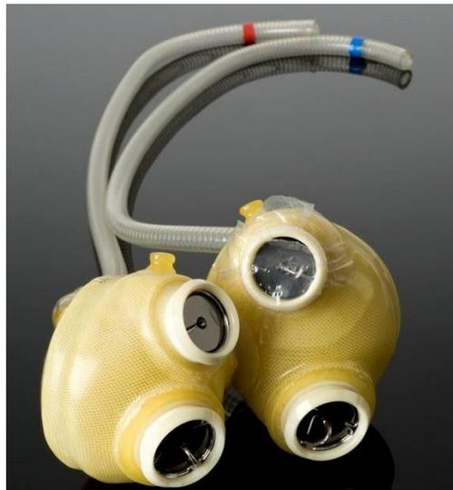
Figura 3.9: Il TAH Jarvik 7: sono visibili le valvole, le sacche in poliuretano e la doppia trasmissione pneumatica [66].
