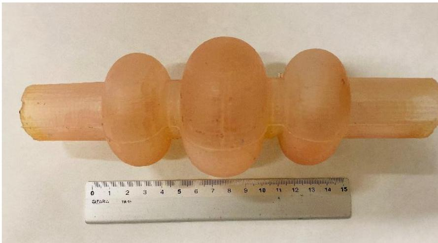
Figura 5.12: Prototipo di camera ventricolare in Cristal Rubber realizzato nel terzo tentativo. Si può notare il colore rosa tenue della gomma probabilmente lasciato dal distaccante siliconico.
