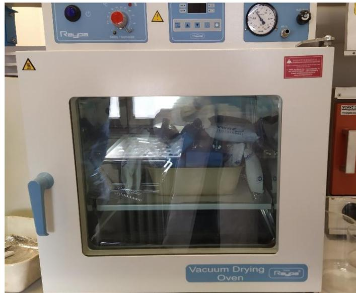
Figura 5.9: Lo stampo viene messo sotto vuoto a temperatura ambiente, permettendo la fuoriuscita dell'aria e delle bolle dallo stampo.
