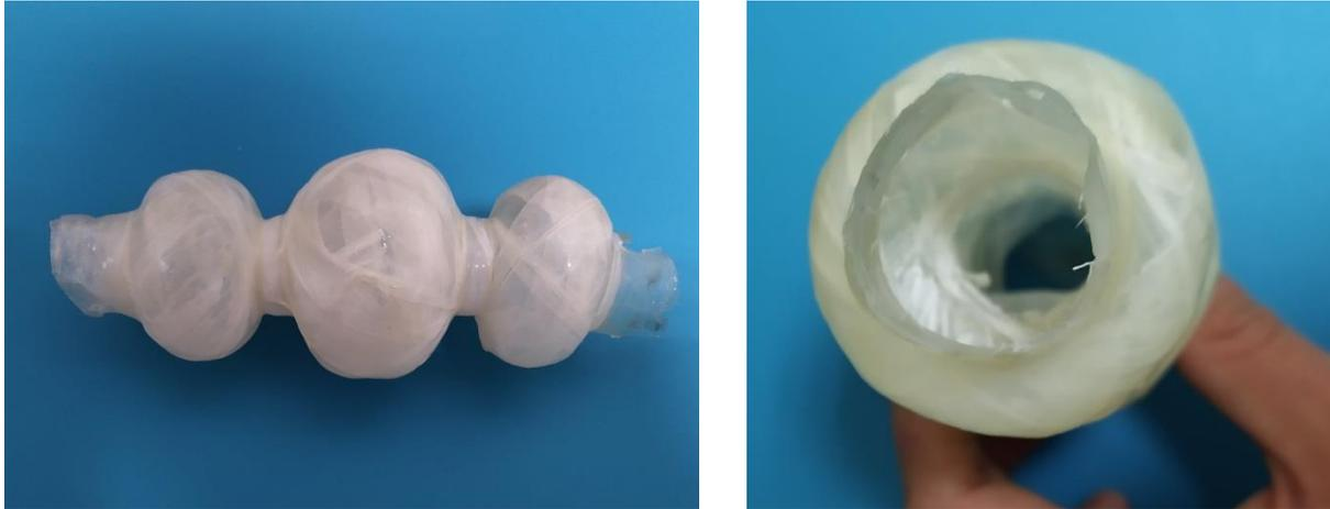
Figura 5.14: Visione laterale e frontale della camera ventricolare realizzata in CronoFlex AR, si possono notare filamenti di Teflon, il quale si è sfaldato e ha intaccato il polimero.
