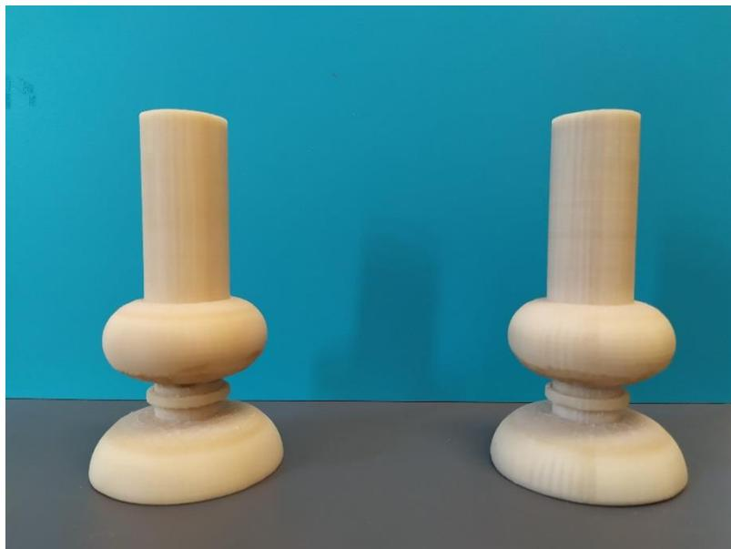
Figura 5.5: Due estremità dell'anima in HIPS: i supporti sono stati rimossi e i modelli sono stati carteggiati. Successivamente le due estremità verranno incollate con colla cianoacrilica.
