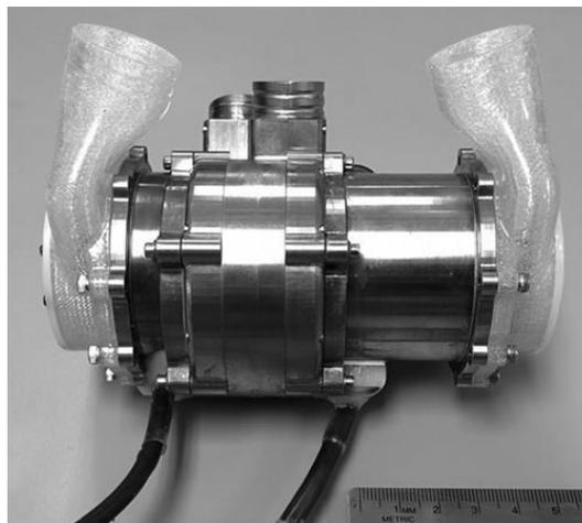
Figura 3.23: Prototipo del TAH OregonHeart realizzato per prove fluidodinamiche.
