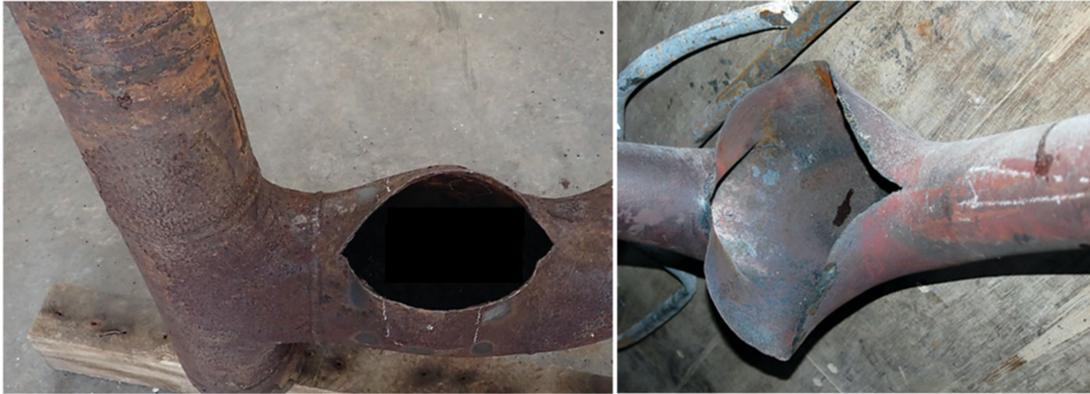
Figura 4-1: Esempio di rottura di tubazioni in acciaio a "bocca di pesce"
