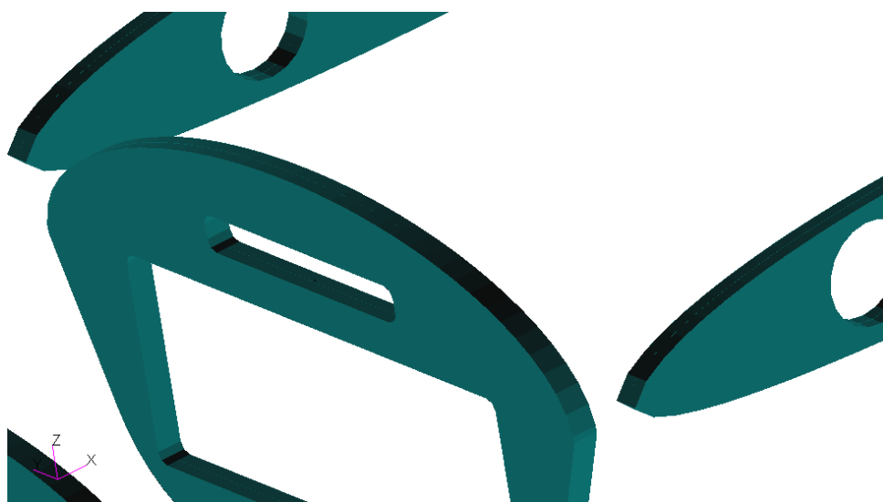
Figura 4.7: Spessore iniziale degli elementi realizzati in PLA
