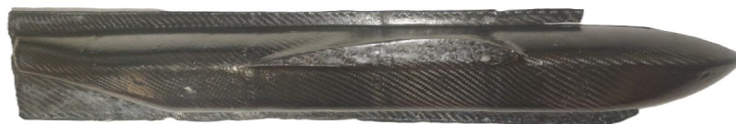
Figura 6.20: Laminato della parte destra della fusoliera
