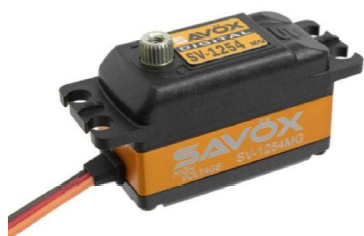
Figura 2.15: Savox SV1254 MG - Due attuatori utilizzati per i mo- tori anteriori
