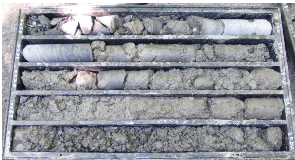
Figura 15: stratigrafia del sondaggio numero 4436 alla profondità di 35-40 m
