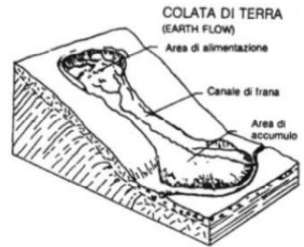
Figura 6: schema frana per colamento
