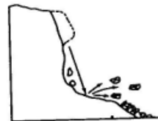
Figura 2: schema frana per crollo
