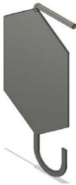
Figura 2-27 Geometria finale della placca per prove di trazione
