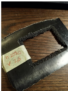
Figura 3-2 Materiale fuso in corrispondenza della superficie lavorata per bassi valori di f_z
