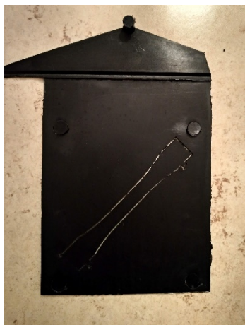
Figura 3-3 Provino per prove di trazione ottenuto mediante taglio ad acqua
