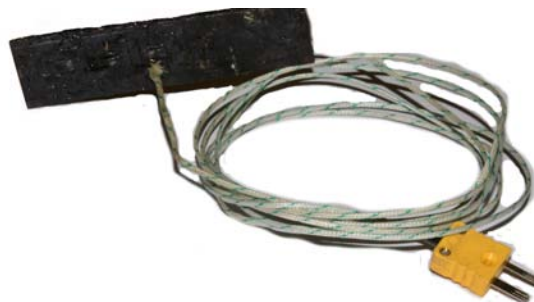
(c) Termocoppia inserita nel laminato
