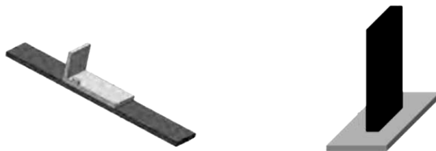
(a) Provino per l'analisi della propagazione della frattura.
