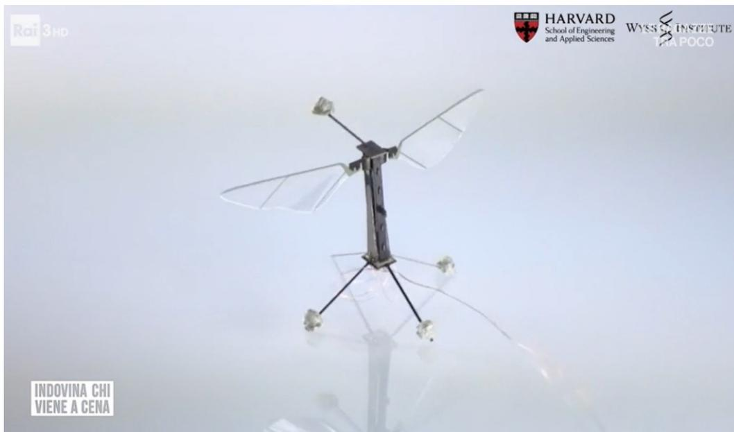
*Figura 12: Prototipo di ape robot presentata dall'Università di Harvard (Massachusetts, USA). Corpo metallico grande quanto una moneta, apertura alare di 3 cm e ali in grado di muoversi in modo autonomo. Tuttavia, al tempo in cui viene presentata nel programma, non è wireless e l'intelligenza artificiale del modello non riesce a riconoscere i fiori.*
