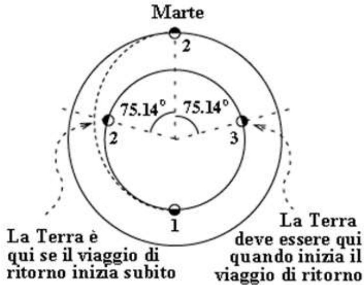
Schema trasferimento di Hohmann per il ritorno [3]
