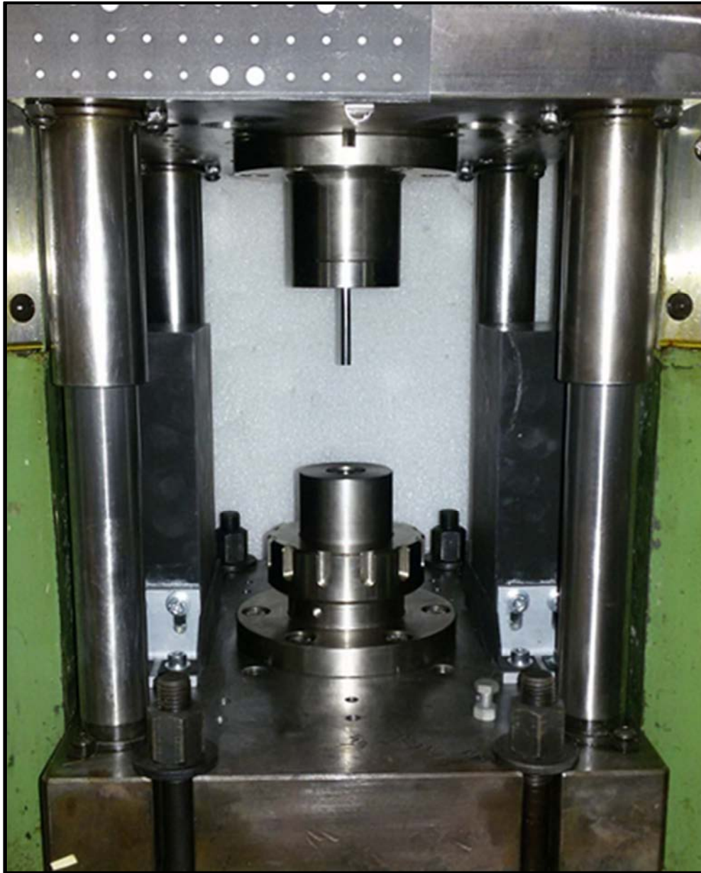
Figura 3.45 Stampi estrusione diretta)
