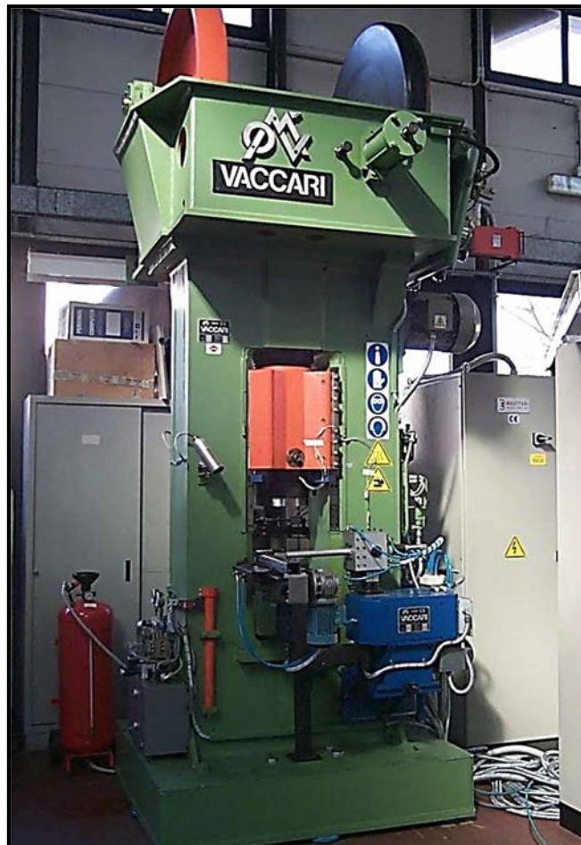
Figura 3.3 Pressa a vite Vaccari 7PS
