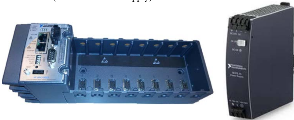
Figura 3.32 CompactRIO collegato allo Chassis ed alimentatore 24VDC
