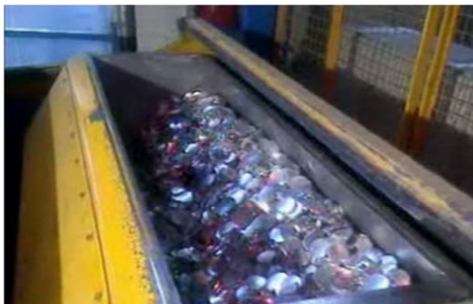
Figura 3.16 Processo di tumbling
