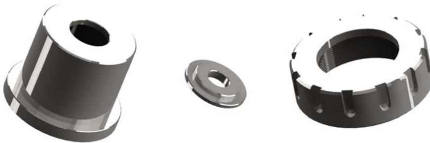
Figura 3.12 Da sinistra: chiusura matrice, anello per chiusura matrice e ghiera
