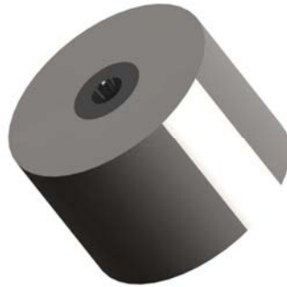
Figura 3.9 Anello di contenimento billetta calettato nel suo stress-ring
