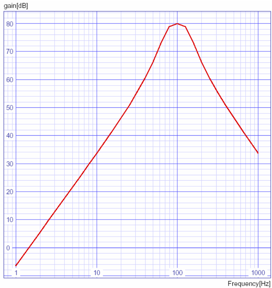
guadagno di tensione sistema ideale, R_2=100k
