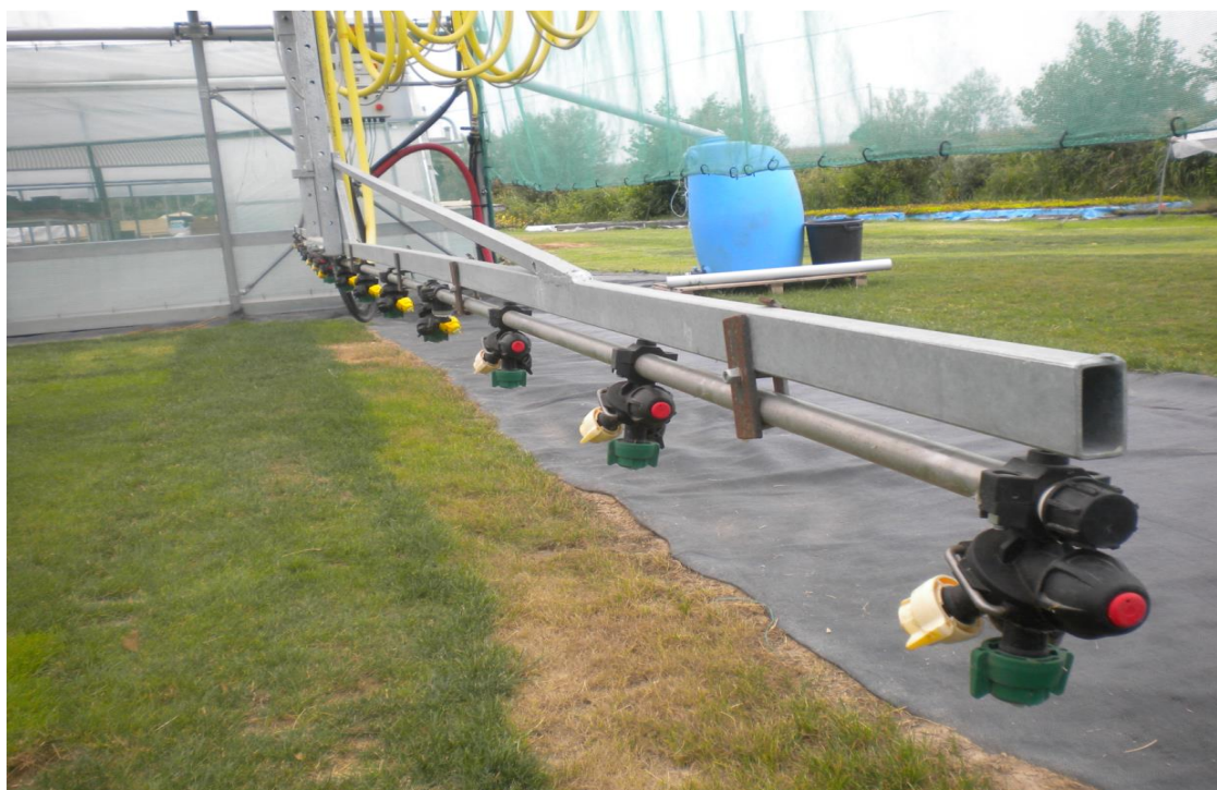
Fig. 16. Particolare dell'impianto di irrigazione: asta con 14 spruzzatori muniti di ugelli da 10 \mu\text{m} (con un angolo di 360°).
