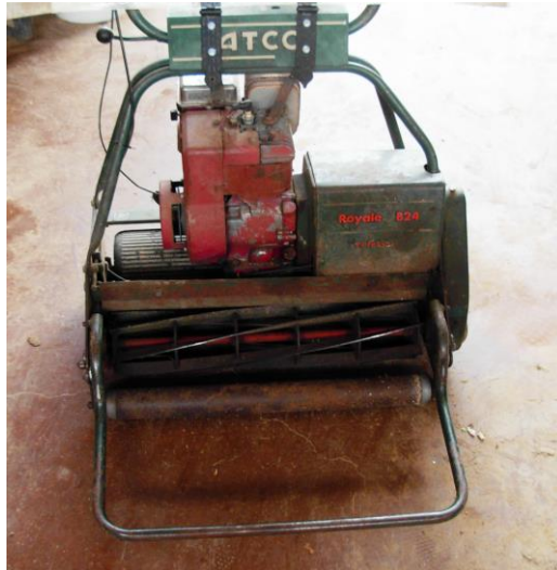
Fig.17. Tosaerba elicoidali semovente a 6 lame utilizzato durante la prova.
